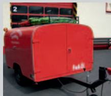
Feuerwehr Anhänger FwA-Öl. Ein alter Tragkraftspritzen Anhänger, Baujahr 1962, wurde umgebaut zur Aufnahme von Gerätschaften zur Ölspurbeseitigung, Kehr und Räumgeräte sowie Ölbindemitteln.
