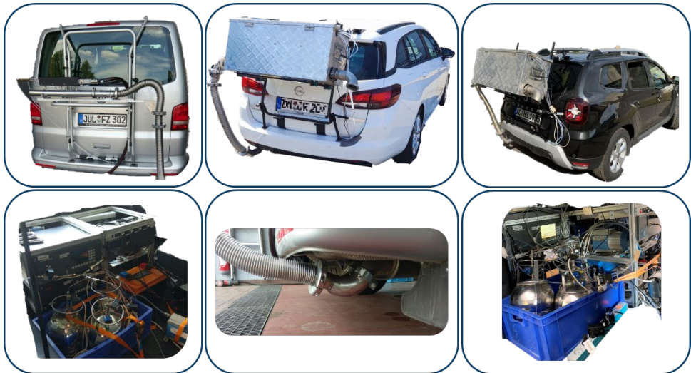
Abbildung 3-11: Messaufbau des Portablen Emissions Mess Systems (PEMS) in den Versuchsfahrzeugen: Volkswagen T5 2.0 TDI (links), Opel Astra K 1.2 Turbo (Mitte) und Dacia Duster II 1.6 SCe 115 LPG (Rechts)
