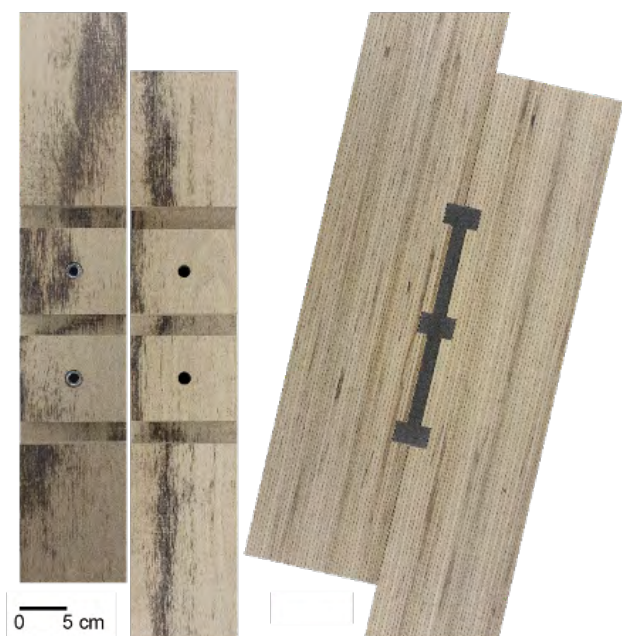
Prüfkörperaufbau in BauBuche-Verbund
