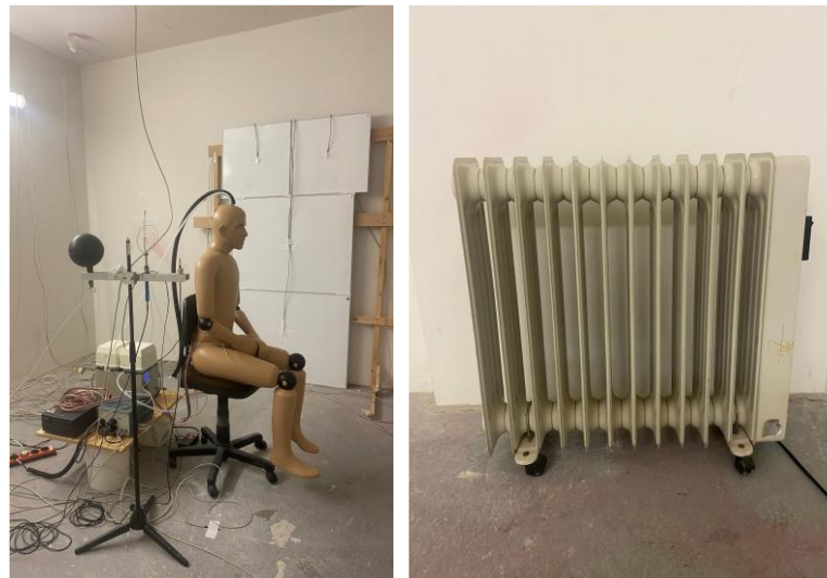
Abbildung 30 Messaufbau mit Thermischem Manikin und Heizplatten (links) und Ölradiator (rechts)
