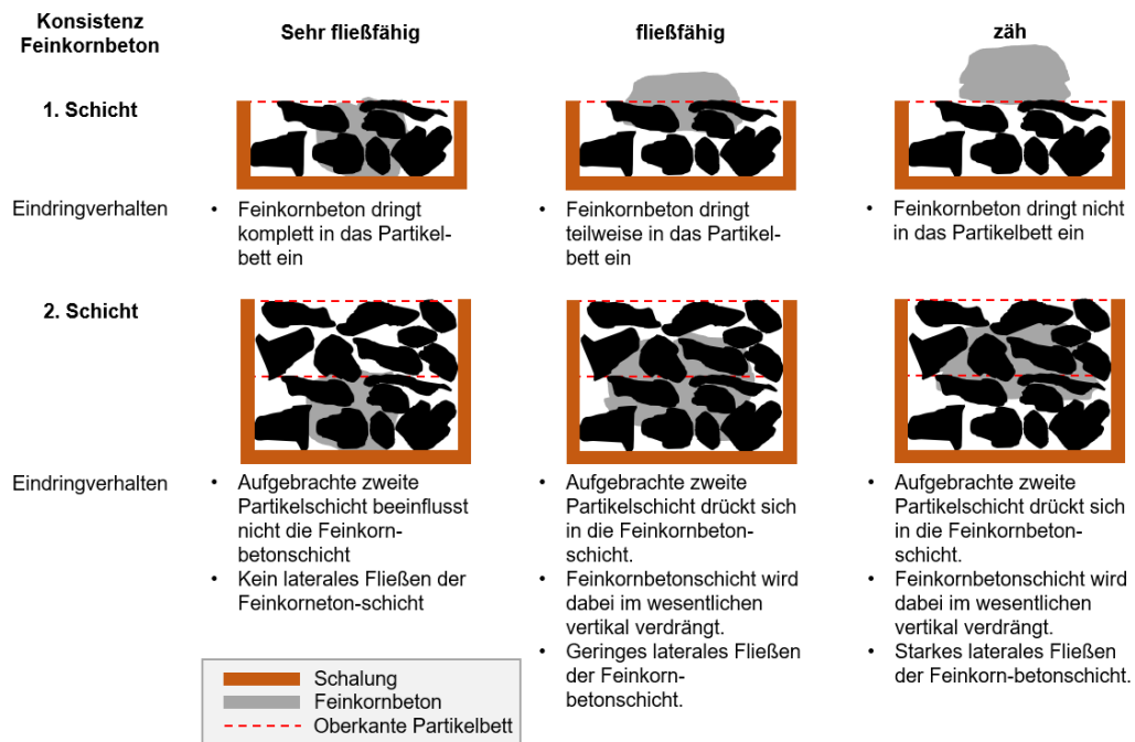
Abbildung 2: Eindringprinzip in Abhängigkeit der Rheologie des Feinkornbetons in ein Partikelbett für sehr fließfähigen (links) Feinkornbeton, fließfähigen (Mitte) und zähen Feinkornbeton (rechts)
