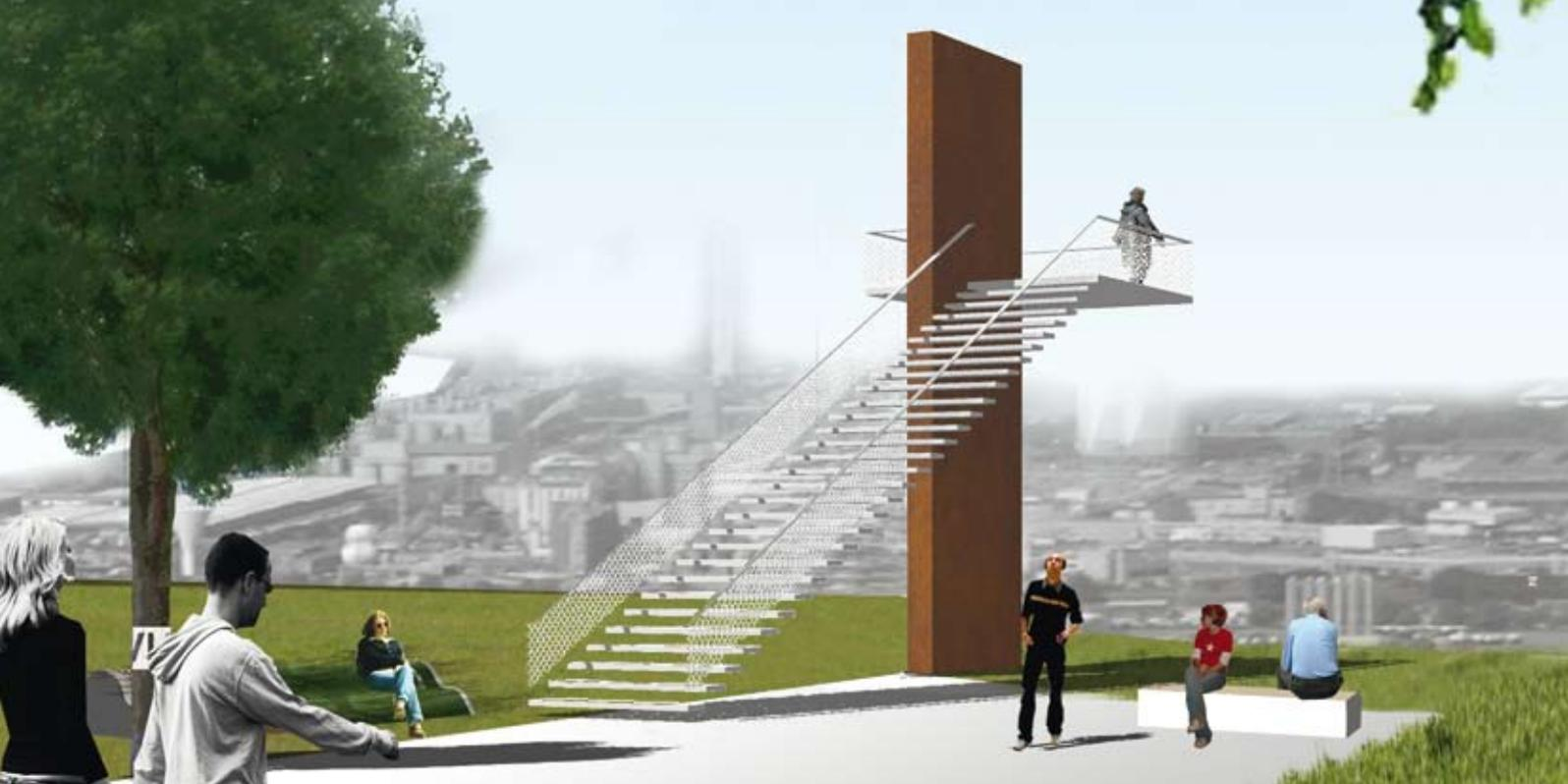
Der Aufbau dieser Mansiones lehnt sich an die römische Mansio an. Die Architektur ist ein modulares System von Betonscheiben und Stahlstele, z.T. überdacht und verglast. Tiefer gelegene Parkplätze und eine randliche Aufwallung, Kiefern und Sitzmöglichkeiten [Rasenbänke, Beton] vervollständigen das Element.
