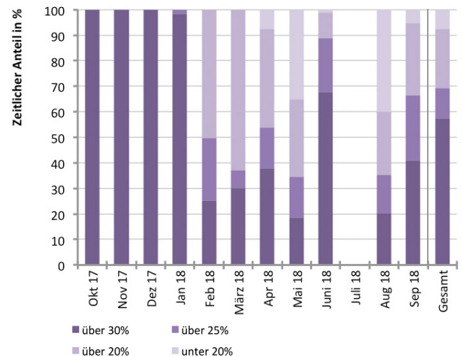
Abb. 415 Kategorisierung der relativen Luftfeuchte im beispielhaften Büroraum
