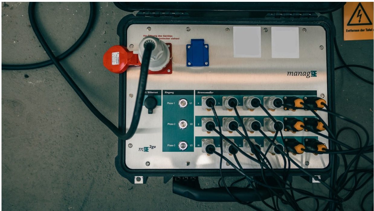
Abbildung 20: Mobiles Messsystem me2go der Fa. manageE GmbH in einer laufenden Messung
