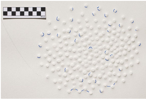
Abb. 11: Kartierung der Stellen, an denen das Fasergefüge durch den Prägeprozess gestreckt wurde. Foto: Hanna Freres (TH Köln).
