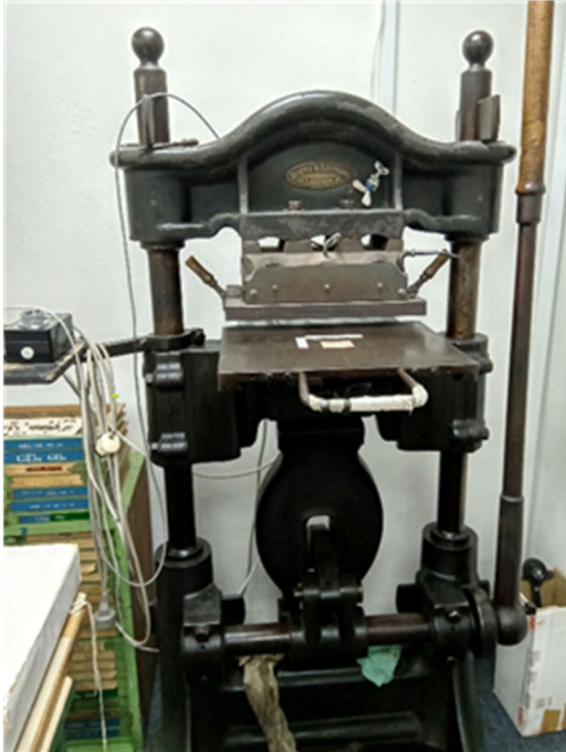
Abb. 1: Zur Herstellung der Blindprägung genutzte handbetriebene und beheizbare Kniehebelpresse.
