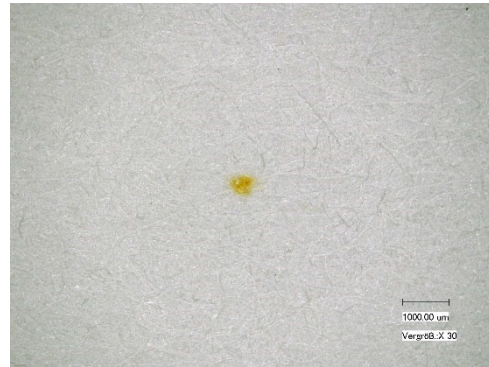
Abb. 14: Unter Tageslichtbedingungen erscheinen oxidierte Metalleinschlüsse als orange-braune Rostflecken.
