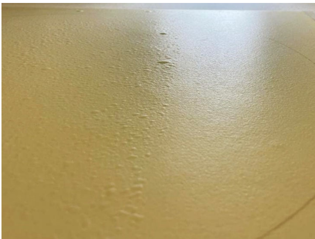
Abb. 15: Objekt nach dem 10-minütigen Bleichbad. Es zeigten sich erste Erscheinungen von Blistering (linke Seite), die mit einem weichen Pinsel ausgestrichen werden konnten (rechte Seite). Foto: Svenja Tempich (TH Köln).
