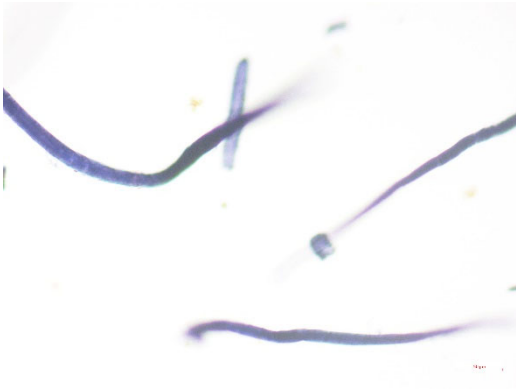
Abb. 30: Fasern des Papierträgers nach der Anfärbung mit Chlorzinkiod.
