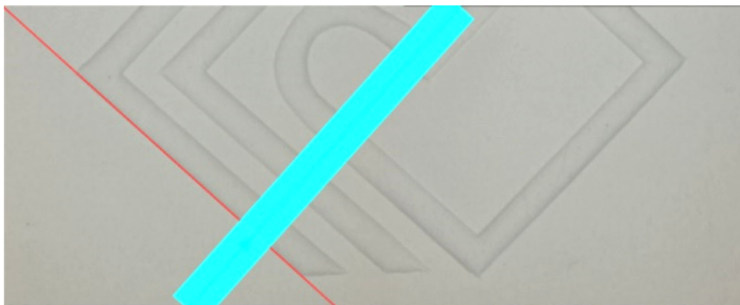
Abb. 5: Exemplarische Ansicht des Probekörpers VDA 160 g/m 2 Ref1. Rot abgebildet ist die Hilfslinie auf die das hellblau abgebildete Lot gefällt wurde. Die berechnete Profillinie ergibt sich aus einem Durchschnitt von 50 nebeneinander liegenden Linien.
