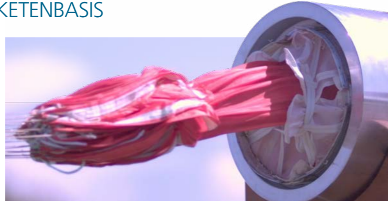
Eine Hochgeschwindigkeitskamera zeichnete auf, wie der Fallschirm aus der Packhülle herausgezogen wird.
