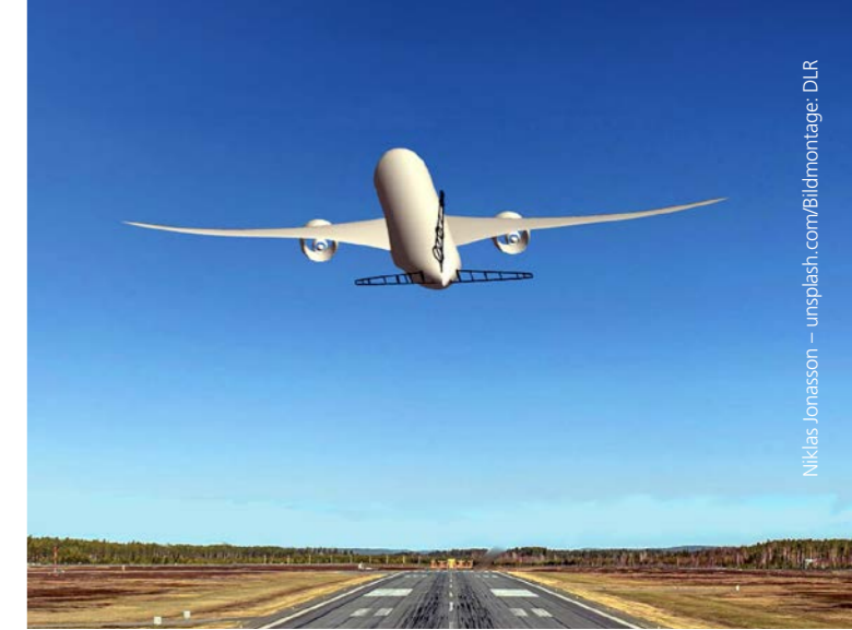
Simulation vom Start eines Langstreckenverkehrsflugzeugs mit hochgestrecktem, lastgeregeltem, ultraeffizientem und intelligentem Flügel
