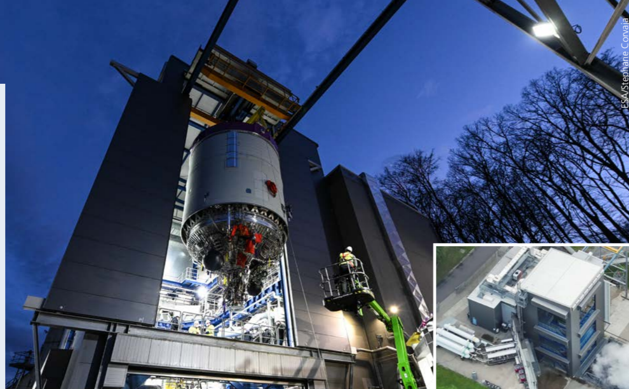
Die Ariane-6-Oberstufe wird am DLR-Standort Lampoldshausen in den Prüfstand P5.2 eingebaut.
