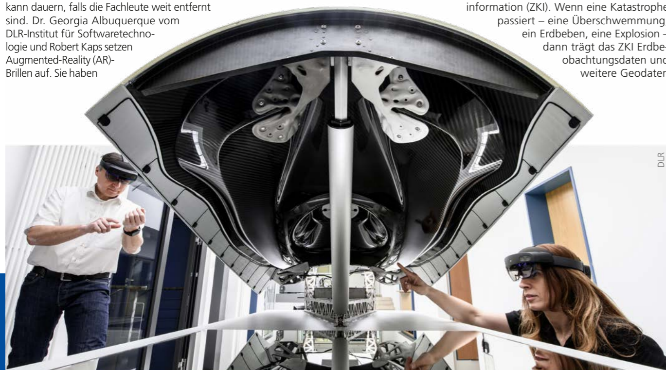
Dr. Robert Kaps (links) und Dr. Georgia Albuquerque arbeiten an der Air-Brake. Über Augmented-Reality-Brillen sehen sie nicht nur das Objekt vor sich, sondern auch den digitalen Zwilling mit seinen Analysewerkzeugen.
