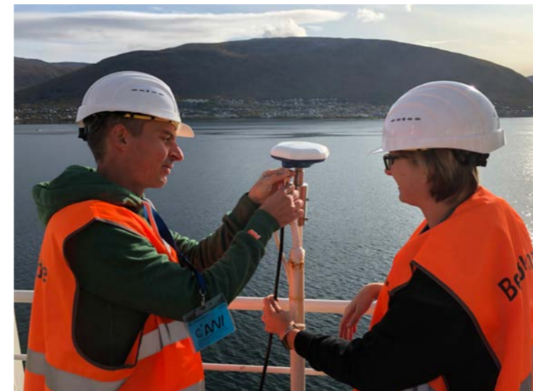
Für das Projekt MOSAiC installierten Forschende eine GNSS-Antenne auf einem Forschungsschiff für Messungen im Nordpolarmeer.
