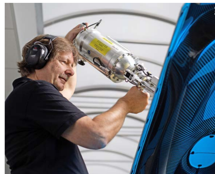
Versuchsaufbau an der Air-Brake: Mit dem Gerät können Belastungen ausgelöst und analysiert werden.
