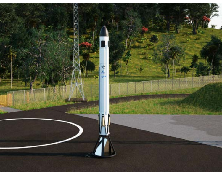
Der CALLISTO-Demonstrator ist elf Meter hoch und soll selbstständig starten und wieder landen können.
