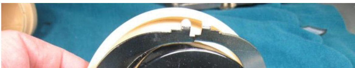
Zwei Blechteile sind in der Grundplatte federnd in den Laschen eingehakt. Dadurch kann die Leiterplatte nicht mehr nach oben und nach hinten rutschen.
