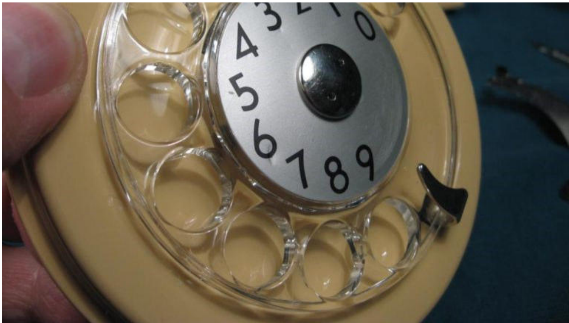
Wählscheibe geputzt und poliert.
