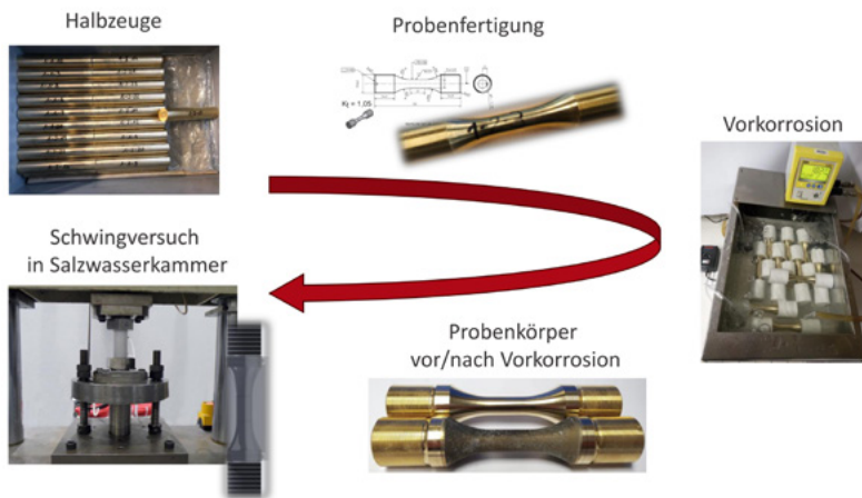
Abb. 3: Herstellung der Proben für die Schwingfestigkeitsversuche
