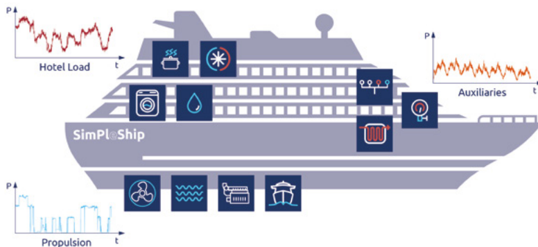
Abb. 2: Hotellast, Antriebsleistung und energetische Bedarfe der Hilfsaggregate tragen zu einem Gesamtenergiebedarf bei, der durch die Energiewandler gedeckt werden muss.
