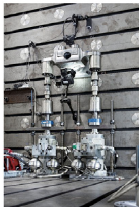
Abb. 7: Großproben (a) und Großversuchsprüfstand (b) des ausgewählten Doppel-Y-Knoten im Labor der TUHH. Die gut sichtbaren weißen Bereiche an den Schweißnähten stammen von den Geometriescans und der Vorbereitung der DIC Messungen. (c) Nahaufnahme der Schweißnähte des Großversuchsrohrknotens mit deutlich erkennbarer Instrumentierung durch Dehnmessstreifen und Rissen entlang der Schweißnähte. (d) Prüfstand für mehrachsige Beanspruchung von Rohr-Flansch-Verbindungen unter Biegung und Torsion inklusive kamerabasiertem Schweißnahtmonitoring zur Anrisserkennung mithilfe von DIC am Fraunhofer LBF.
