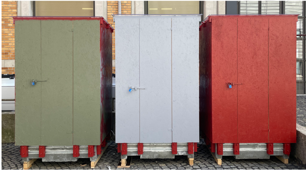
Abbildung 6: Prüfhäuser der Langzeitscherversuche in NKL2
