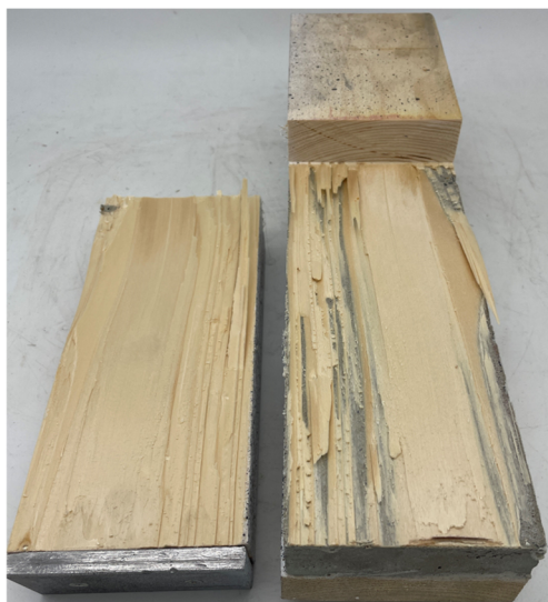
Abbildung 19: Bruchbild C1K1_NKL2_3 nach Prüfung der Restscherfestigkeit
