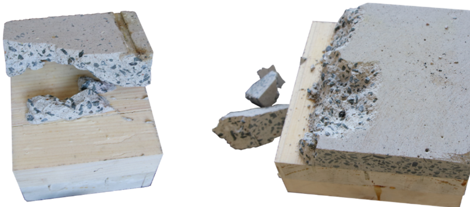
Abbildung 91: Exemplarische Bruchbilder des Probekörpertyps A (links) und des Probekörpertyps B (rechts)
