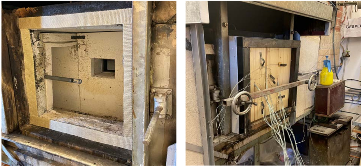
Abbildung 36: Öffnung des Prüfofens (links) und vor der Öffnung eingebauter Prüfkörper (rechts)
