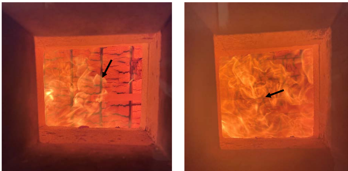
Abbildung 38: Prüfkörper unter einer Brandbeanspruchung nach Einheitstemperaturkurve nach 60 Minuten (links) und 66 Minuten (rechts)
