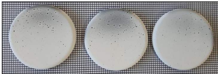
Abbildung 108 Defekte (schwarze Punkte) auf YSZ-PS-PVD Topcoat-Oberfläche
