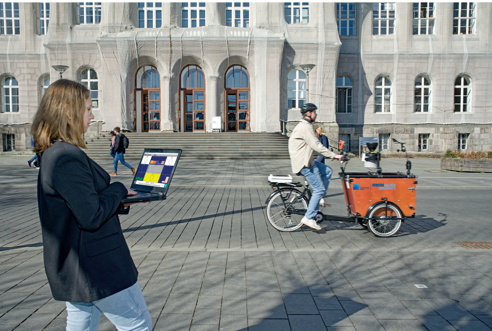
Bild 7: Während der aktiven Messung erfasst das Messfahrrad klimarelevante Daten. Die Sensoren liefern hochaufgelöste und präzise Werte, die direkt drahtlos übertragen werden.
