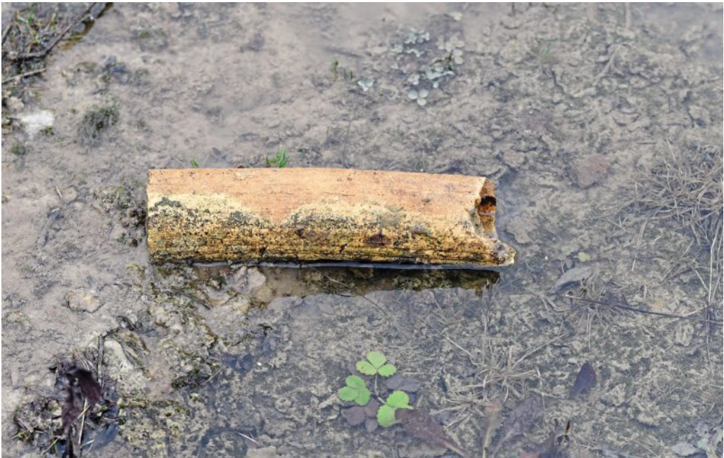
Abb. 2: Seit dem 19. Jahrhundert wurden Tonröhren zur Entwässerung landwirtschaftlicher Flächen genutzt (NW: MS) (GU: 1.2.2). (Foto: T. Fartmann)
