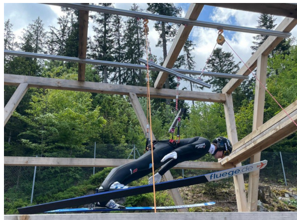
Abb. 1: Aufhängevorrichtung der Flugsimulationsanlage mit Athlet in Fluglage.
