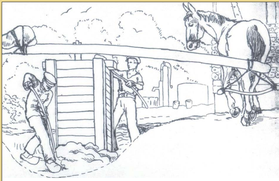
Lehmmühle in Funktion; viele Jahrhunderte lang wurde so die Füllungen der Gefache mit dem Stroh-Lehm- Gemisch vorbereitet; Abb. aus: Verein „Heimstätte“ Dünne, Kreis Herford (Hrsg). Ein alter Baumeister, und was wir von ihm gelernt haben. Dünne o.J. (um 1920), S. 17.
