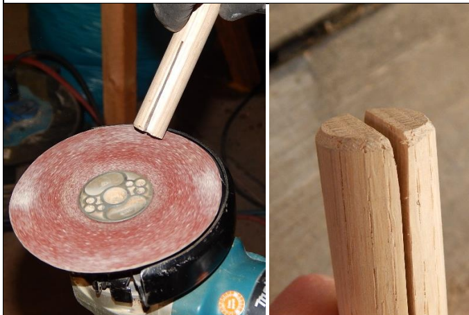
Vorbereitung für den Einbau der Holzkeildolle: umlaufendes Anfasen der Keil- und Dollenkante auf der Seite des verdeckten Keils
