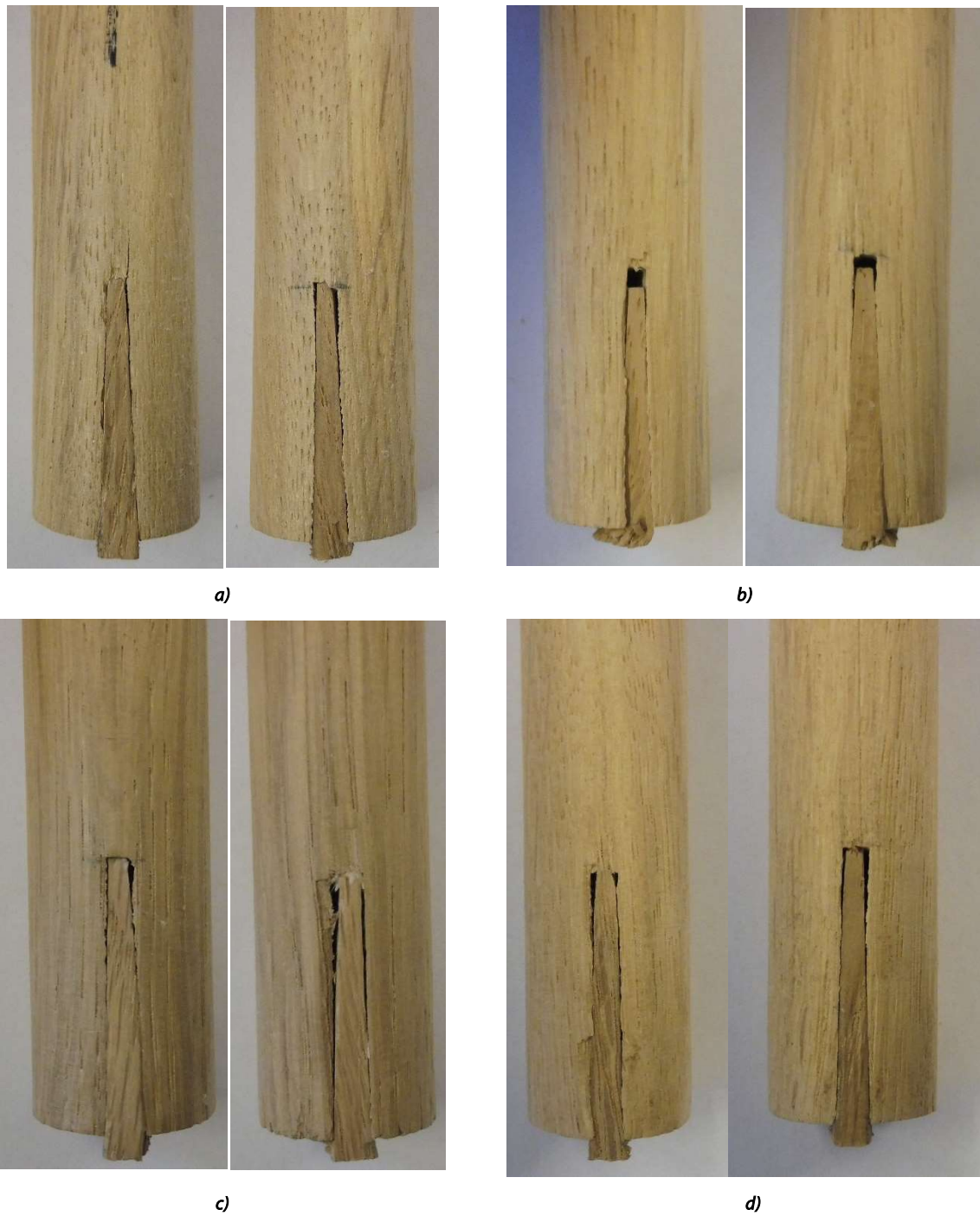
Abbildung 3-17 Rissbildung der Nutboden nach der Zugprüfung: a) H1_T2-45:d ; c) b) H1_T2-90:a; c) H1_T2-90:e; d) H2_T2-0.
