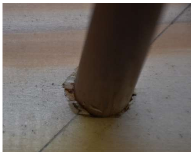
Abbildung 3-11 Geänderte Rissbildung auf S1* in den Prüfkörper H1_T2-45:a nach Zugprüfung (TV2)
