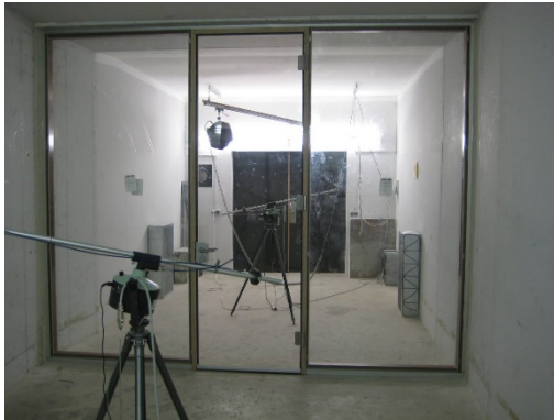
Abbildung 40 Wandprüfstand P2 mit unterdrückter Flankenübertragung.
