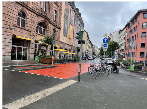
Einfahrt aus Richtung Süden nur für Rad, Rechts-rein-rechts-raus für Kfz Quelle: Planersocietät
