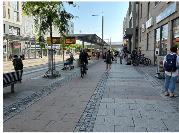
Gestaltung des Gehwegs mit Radverkehrsstreifen im Bereich der Haltestelle – Potenzielle Konfliktsituation Zufußgehende / Radfahrende
