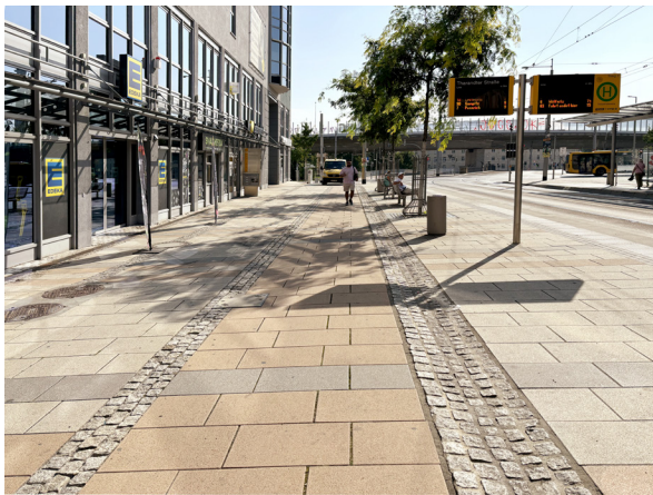
Gestaltung des Gehwegs mit Radverkehrsstreifen im Bereich der Haltestelle
