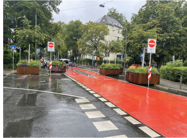
Sperrung für Kfz bei Durchfahrtsmöglichkeit für den Radverkehr und Bus Quelle: Planersocietät
