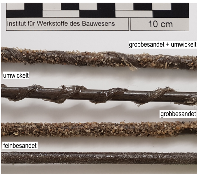
Abb. 6: Profilierungsvarianten der Hanfbastbewehrungsstäbe, Foto: Universität der Bundeswehr München
