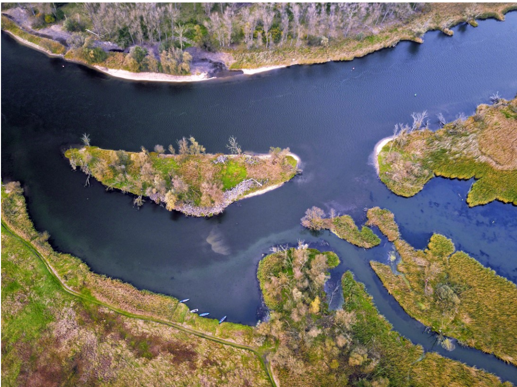
Abb. 9: Renaturierter Flussabschnitt; Altarmanschluss (unten), renaturiertes Ufer (Insel und oben) sowie Anschluss einer Flutrinne (oben) (Foto: NABU IFA)
