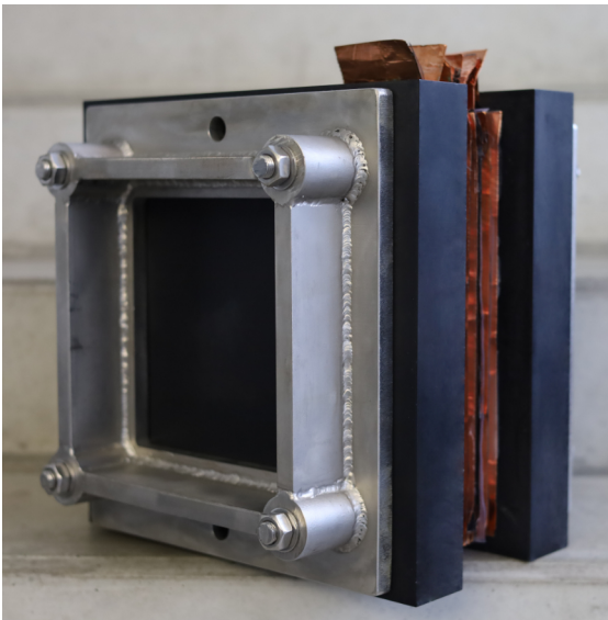
Modell einer Versuchsanlage zur fließkapazitiven Deionisierung (FCDI)
