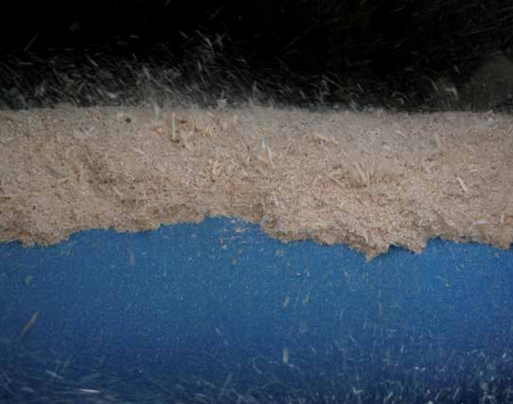
1. CONDUCTO®-Prozessbänder für die Holzspan Trocknung 2. PAD-Naht 3. CONDUCTO® 5065
