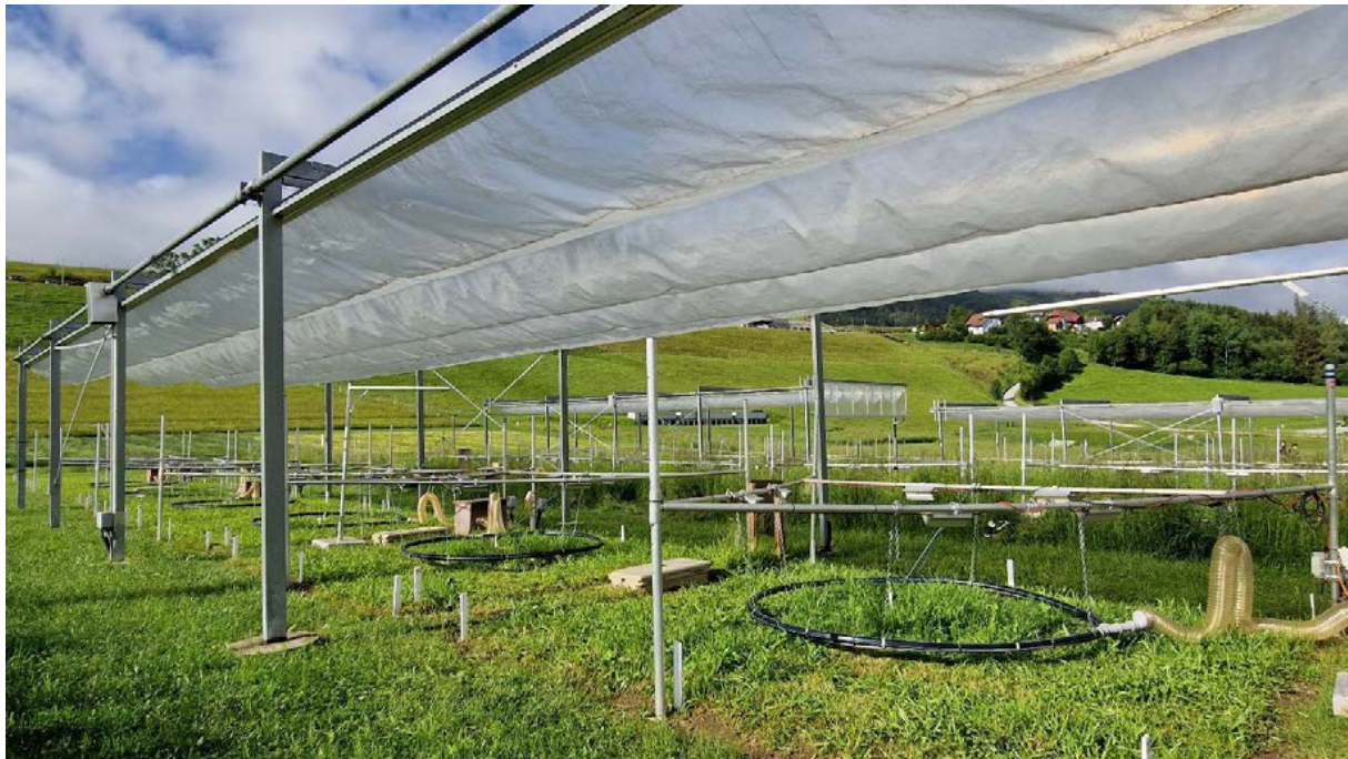
Abb. 11: Versuchsanlage ClimGrass mit Regendächern, CO 2 -Begasungsring und Infrarotstrahler (Quelle: A. Schaumberger)
