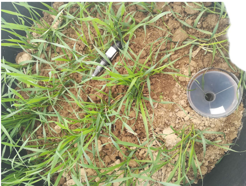
Abb. 7: Blick in das Innere einer Photoeklektorfalle mit Barberfalle und Temperatursensor (Foto: C. Jakubassa).
