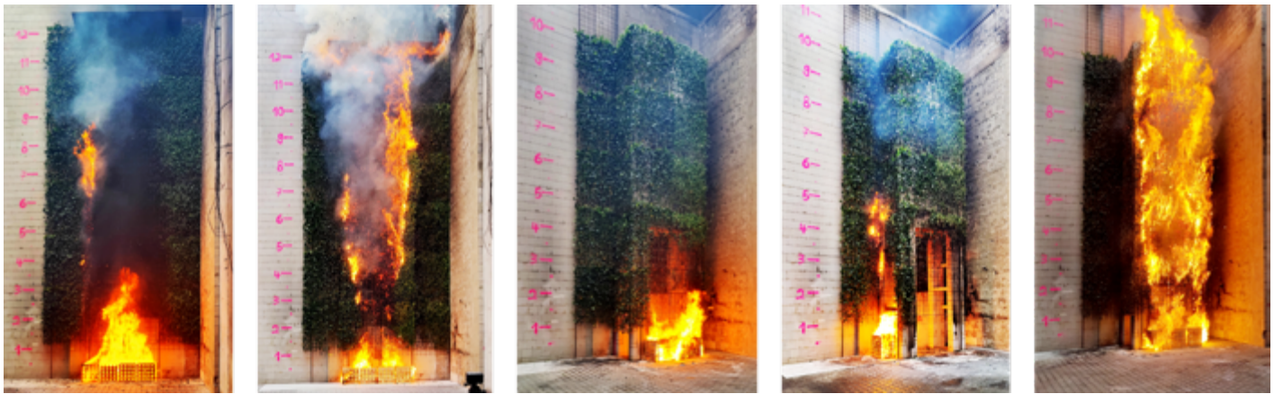
Abb. 5: (v. l. n. r.): Flächiger Versuch mit vitaler Begrünung (V1); Flächiger Versuch mit getrockneter (toter) Begrünung (V2); Balkonversuch mit zentraler Brandeinwirkung und vitaler Begrünung (V3); Balkonversuch mit Brandeinwirkung in der Ecke und vitaler Begrünung (V4); Balkonversuch mit zentraler Brandeinwirkung und getrockneter (toter) Begrünung (V5), Foto: Thomas Engel
