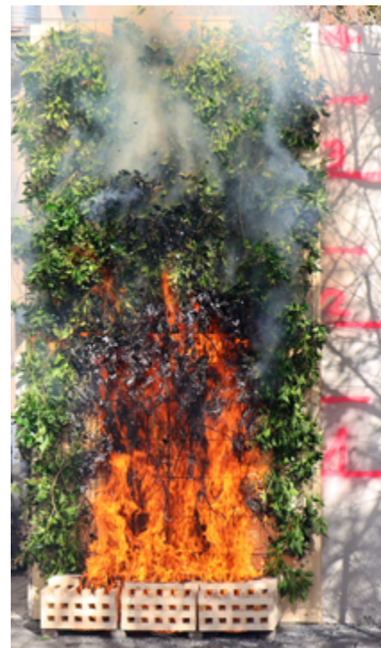
Abb. 4: Fotodokumentation des Brandversuchs Test 3 mit Holz- und Grünfassade zur 3. Prüfminute, Foto: Thomas Engel
