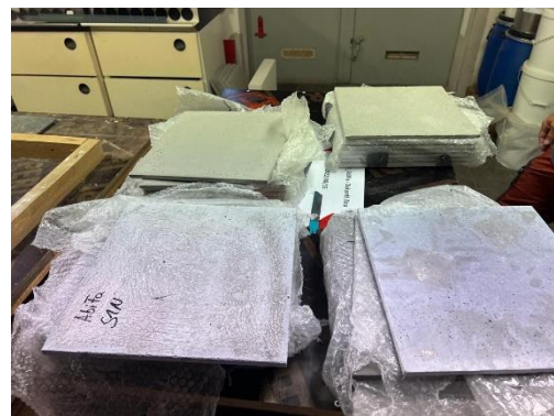
Abbildung 13. Probenherstellung Stufe 2: AbifFA; Links: mit dem Frischbeton befüllte Schalungen, rechts: nach 28-tägiger Lagerung in Kalkwasser ausgehärtete Prüfkörper
