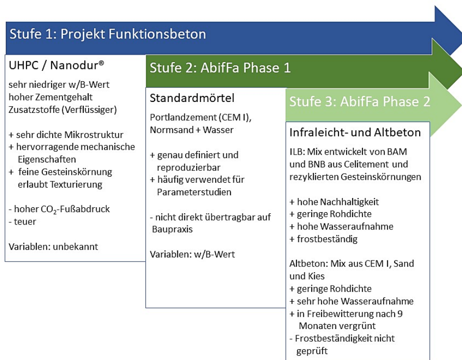
Abbildung 11. Schema zur Entwicklung der Betonsubstrate
