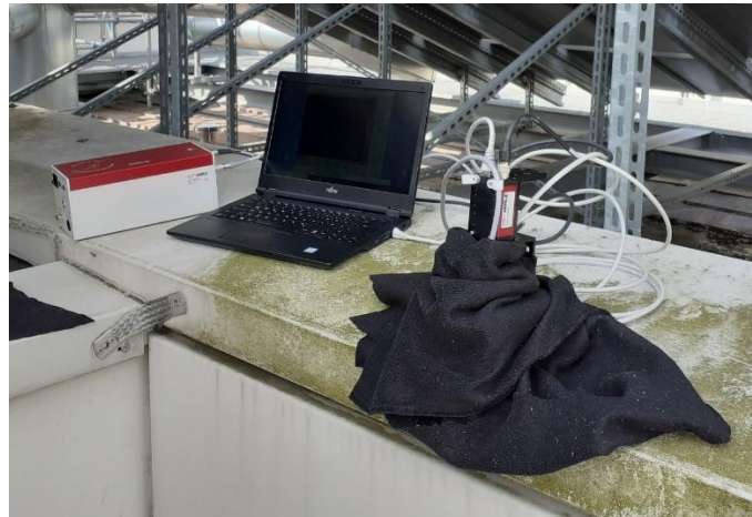
Abbildung 29. Durchführung einer PAM-Messung im Labor (links) sowie im Freien (rechts). Das schwarze Textil dient der Dunkeladaption des Messbereichs
