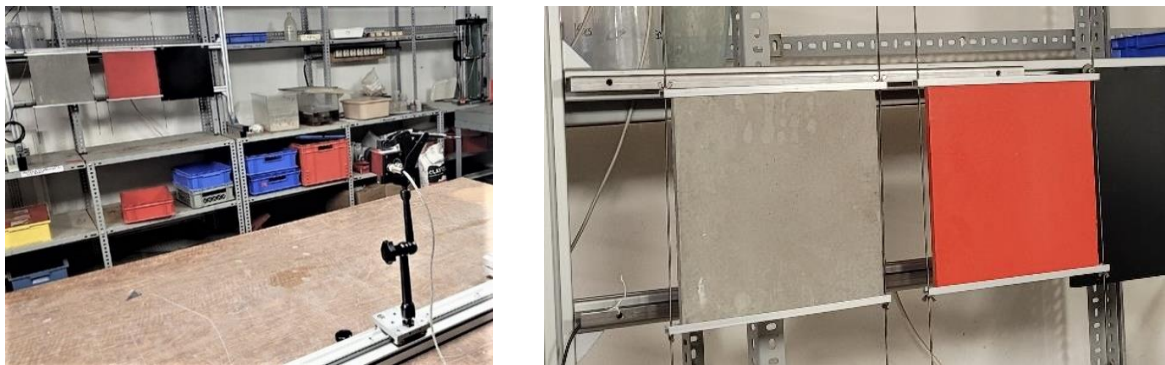
Abbildung 58. links: Überblick Messaufbau Thermografiekamera, rechts Betonsubstrat und Referenzfläche an Waage befestigt.
