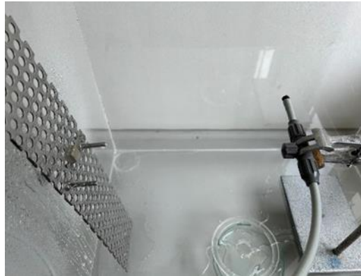
Abbildung 31. Versuchsaufbau zur Bestimmung der Adhäsion des Biofilms an der Substratoberfläche
