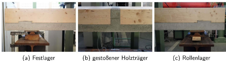
Abbildung 2.29 Konstruktive Ausbildung des Versuchsstands
