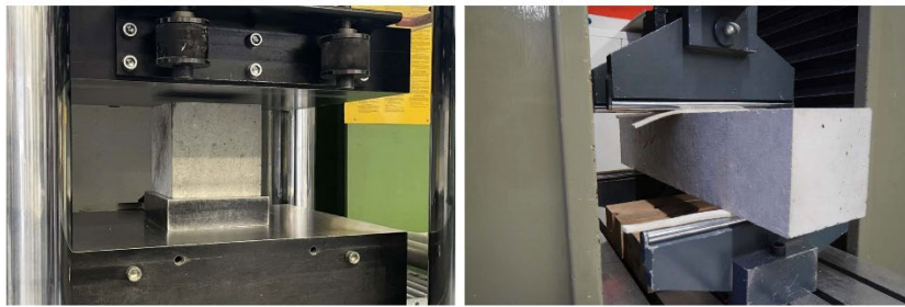
(a) Betonwürfel nach [DIN EN 12390-3, 2019], (b) Biegezug nach [DIN EN 12390-5, 2019]
