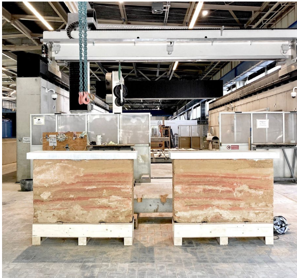
Abbildung 49: Stampflehmelemente hergestellt in robotischer Fertigungsweise
