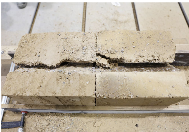
Abbildung 37: Brechen von Material im Zuge eines Unterschnitts
