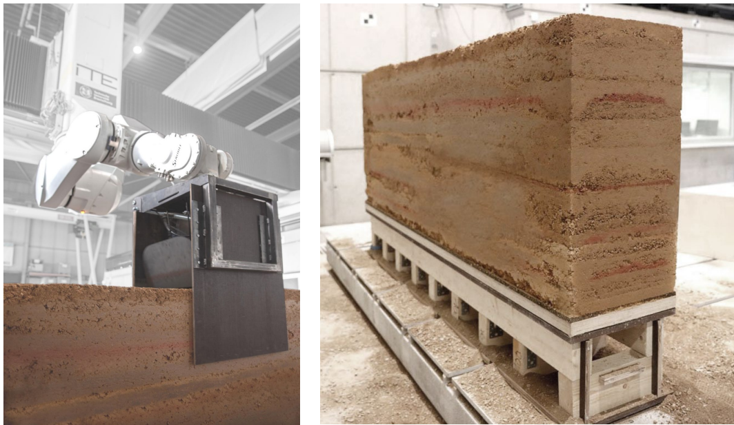
Abbildung 15: Robotischer Endeffektor bestehend aus aktiver Gleitschalung und Verdichtungsgerät (a); Stampflehm-Bauteil 250 x 45 x 100 cm (b)
