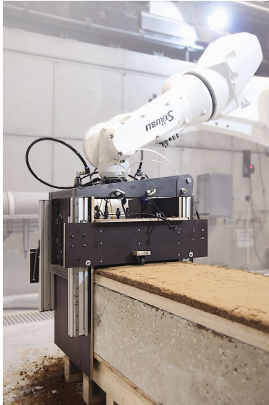
Abbildung 7: Gleitschalung mit zu öffnender Schalungsseite und integrierter Stirnseitenschalung
