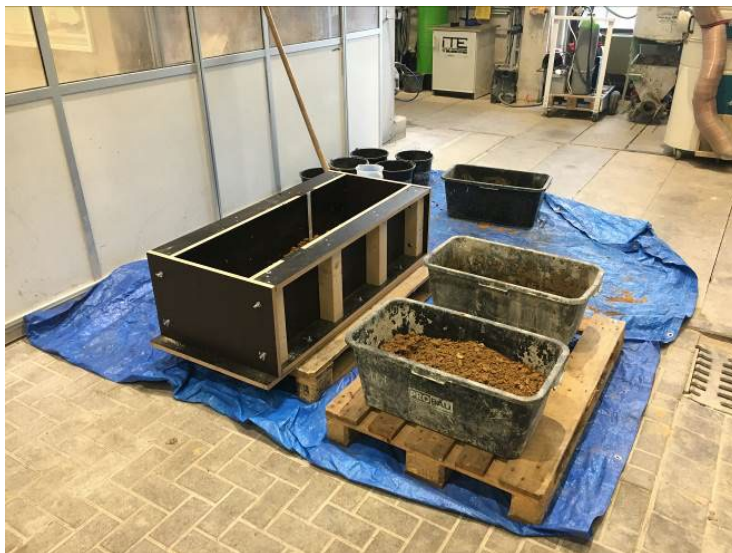
Abbildung 17: Statische Schalung zum Erstellen von Probekörpern
