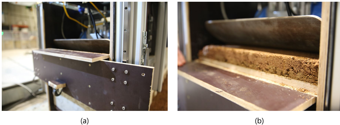
Abbildung 9: Aktive Stirnseitenschalung. Die Schalungstore können aktiv in Z-Richtung (+/-) bewegt werden und erlauben so das Schalen der Stirnseiten am Bauteilende
