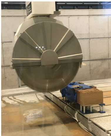
Abbildung 18: Der Probekörper wird von einer CNC gesteuerten Kreissäge in Probewürfel (20x20x20 cm) zerschnitten
