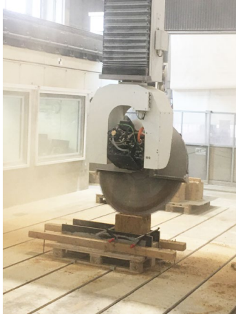
Abbildung 34: Subtraktive Nachbearbeitung von Stampflehm mittels CNC-gesteuerter Diamantkreissäge (DKS)
