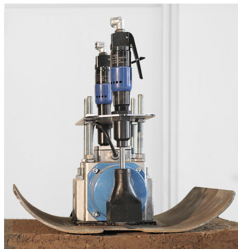
Abbildung 4: Verdichtungsgerät 2 mit Unwuchtmotor Eviro A30-18,2-2 und pneumatischen Randverdichtern
