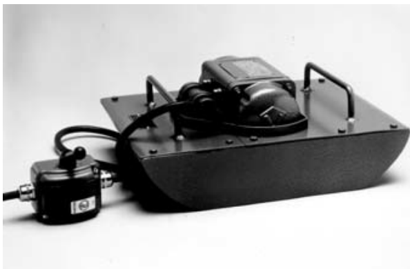
Abbildung 2: Elektronische Rüttelplatte, entwickelt am FEB der Universität Kassel [Min2013]
