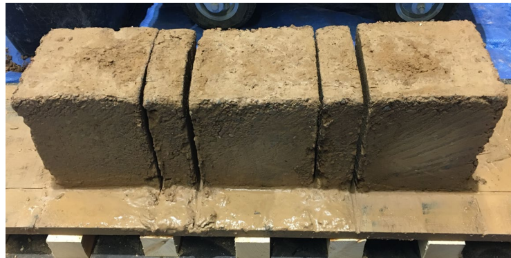
Abbildung 19: Das Resultat des Schneideversuchs: Stampflehmprobewürfel mit Kantenlängen von 20 cm
