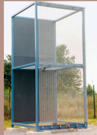
Die Ästhetik von Architekturgeweben demonstriert GKD an einem sogenannten Mock-up-Turm.
