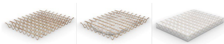
Abbildung 12 Konzept für Verbundbauweise: Additiv hergestellte 3D-Holzgitterstruktur (links), Biowachstum des Myzelium-Substrat-Gemischs in Holzstruktur (mitte), finales Verbundpanel (rechts)
