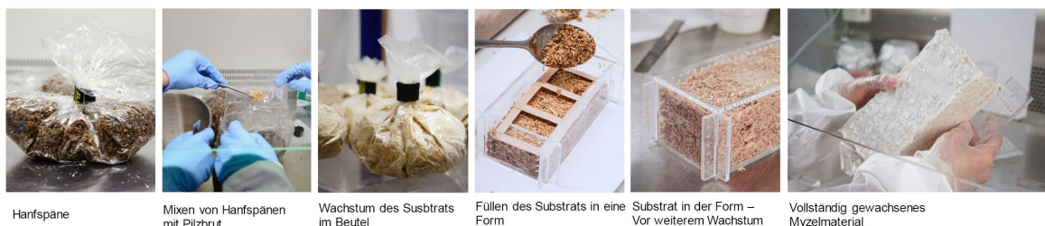
Abbildung 29 Biowachstumsprozess in sechs Arbeitsschritten.
