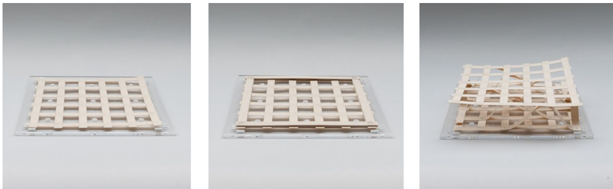
Abbildung 27 Holzgitteranordnungen für die Bewehrung, von links: 2D-Gitter, 2D-Gitter mit massiven Seiten, 3D-Gitter
