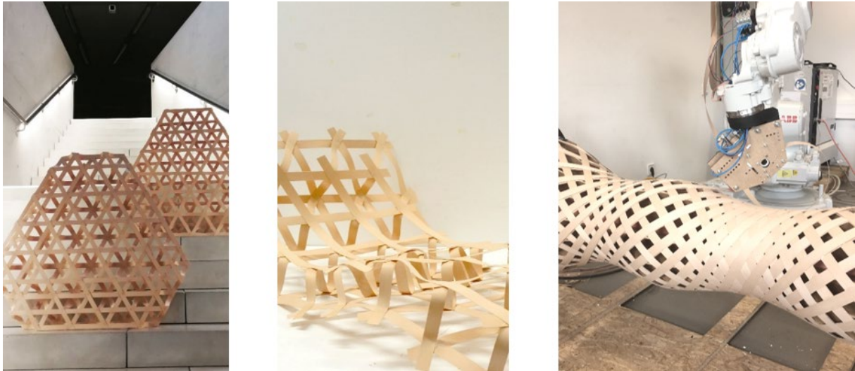
Abbildung 9 Robotisches Wickeln von Freiformen mit gradueller Materialverteilung, Universität Kassel.
