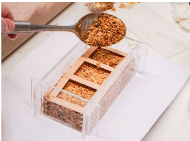
Abbildung 20 Substrat kombiniert mit 2D-Holzarmierung.
