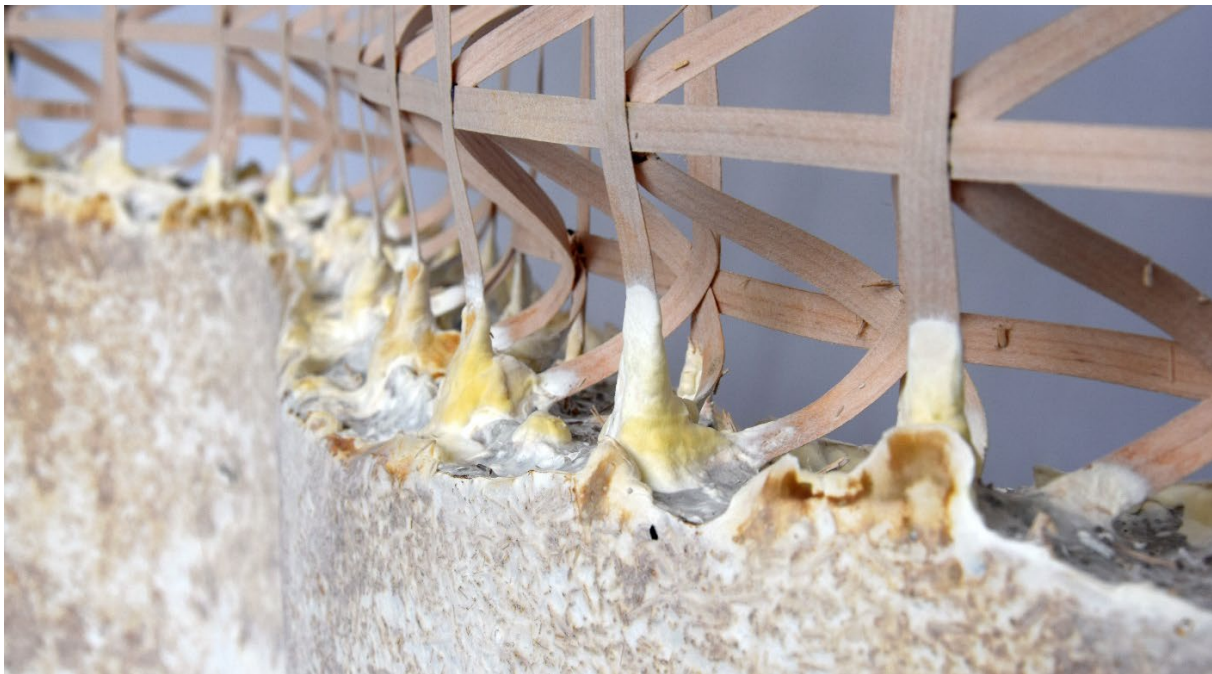
Abbildung 46 Nahaufnahme der Schnittstelle zwischen Myzel und Bewehrung.
