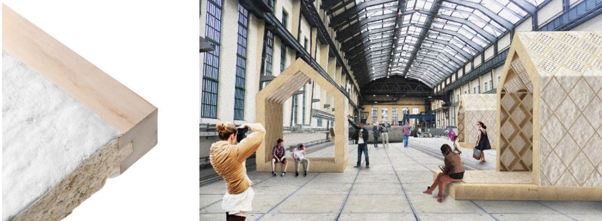
Abbildung 4 Konzepte von ARUP / Mogu zum Einsatz von vorfabrizierten Myzeliumbauteilen, beispielsweise zur Verbindung von Myzeliumpanelen in Holzrahmen
