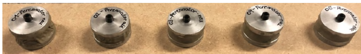
Abbildung 17 Zusammengesetzte Proben für die dynamisch-mechanische Prüfung.
