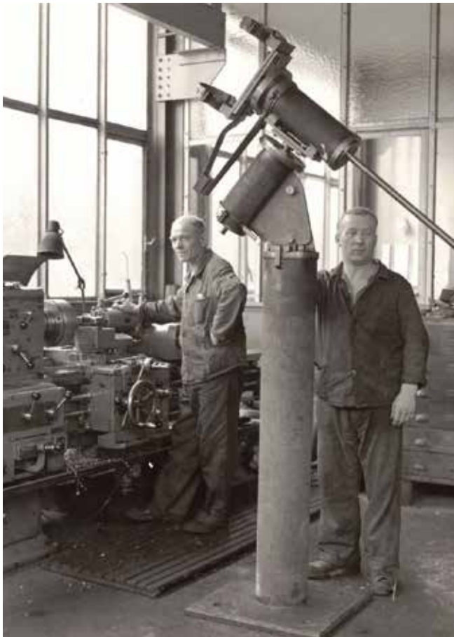
Bild 9: Nach Plänen von Walter Padberg wurde die Säule für das rekonstruierte Pauly-Refraktor auf Vermittlung von Herrn Braun bei der Firma Knappsack-Griesacker AG gebaut. (Foto: Werksfoto)
