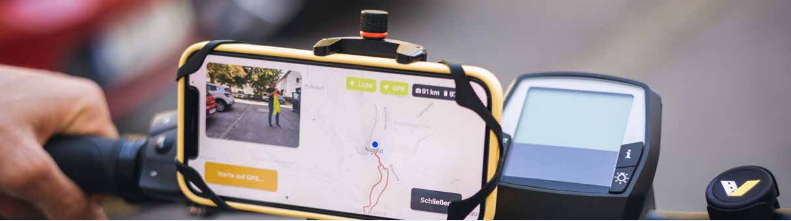
Zustandserfassung von Straßen- und Radwegeinfrastruktur mittels Smartphonekamera | Quelle: vialytics GmbH
