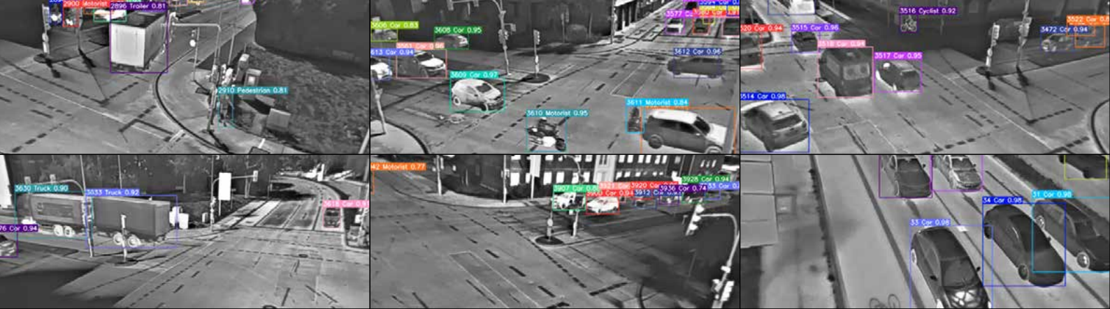
KIVI vernetzt Echtzeitdaten via KI, um Ampelschaltungen sicherer zu gestalten | Quelle: ifg Ingolstadt
