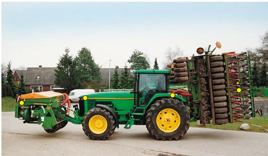
Seitliche Kenntlichmachung mit Anbaugeräten bei mehr als 6 m Länge.
