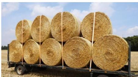
Spanngurte sind Sicherungsmittel, die u. a. bei Stroh- oder Heuballen, Kisten oder Maschinen zur Ladungssicherung dienen. An den meisten Anhängern fehlen die Aufnahmen für die Haken der Spanngurte. Die Hersteller müssen dies künftig berücksichtigen. Nachrüstungen dieser Aufnahmen dürfen nur von Fachpersonal vorgenommen werden.
