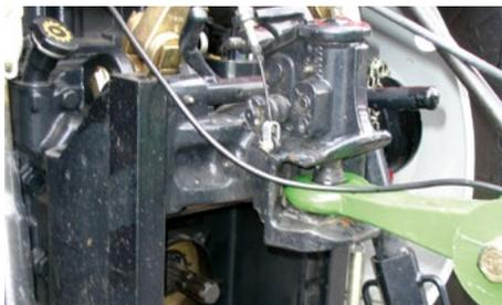
Die Stützlast bei der Bolzenkupplung beträgt in der Regel 2,00 t.
