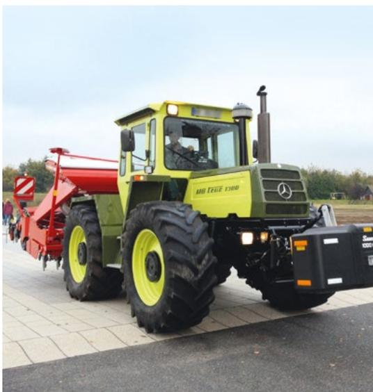
*Beim Anbau von schweren Heckanbaugeräten kann durch ein Frontgewicht die sichere Lenkbarkeit des Traktors erreicht werden. Die Kenntlichmachung des Frontgewichts ist hier gut gelungen.*
