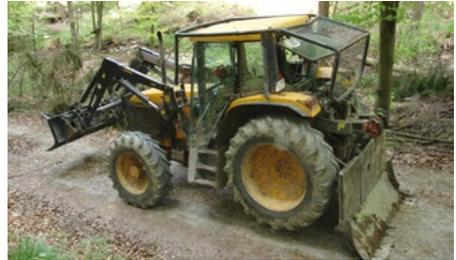
Ständig am Schlepper verbleibende Anbau- oder Ausrüstungsteile von Anbaugeräten ändern das Leergewicht des Fahrzeuges; dies ist bei Nachrüstung in den Fahrzeugpapieren nachzutragen (Merkblatt für Anbaugeräte; siehe Literaturverzeichnis).
