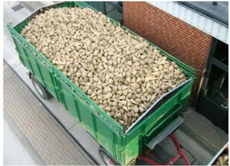
*Die Erhöhung von Seitenklappen dient als Ladungssicherung für Schüttgüter. Mit ausreichendem Abstand zur Oberkante der Bordwand können etwaig rollende Güter wie Rüben, Kartoffeln etc. aufgefangen werden. Die Fahrgeschwindigkeit ist der Ladung anzupassen.*
