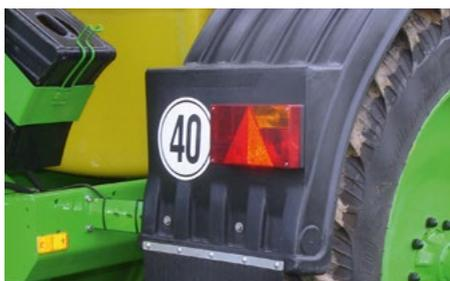
Häufig wird die zulässige Höchstgeschwindigkeit von angehängten lof Arbeitsgeräten heckseitig angebracht. Der Hersteller gibt die Höchstgeschwindigkeit vor.
