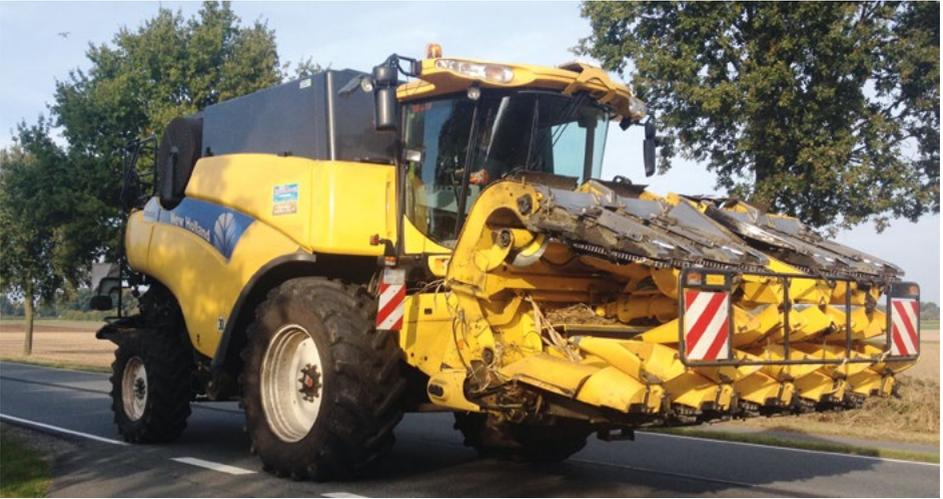
Bei einer Überbreite von mehr als 3,00 m oder einer Achslastüberschreitung von mehr als 11,5 t sind eine Ausnahmegenehmigung gemäß § 70 StVZO und eine Erlaubnis nach § 29 StVO erforderlich.
