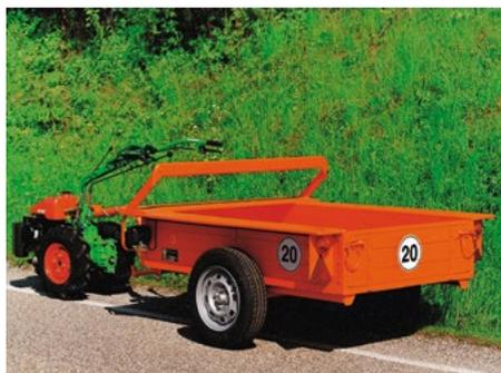
*Beleuchtungseinrichtungen an Einachsschlepper mit einachsigen Anhänger.*
