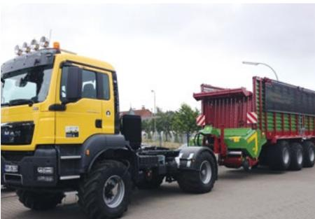
*Der Agrar-Lkw kann Anhänger ziehen und auch Geräte antreiben. Ausgestattet mit einer Reifendruckregelanlage ist eine bodenschonende Befahrung der Felder möglich.*
