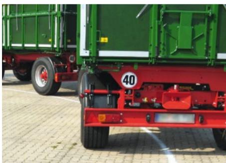
Die bauartbedingte Höchstgeschwindigkeit wird am Anhänger durch ein Schild dargestellt.
