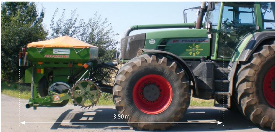
Bei Überschreitung des Vorbaumaßes muss durch geeignete Maßnahmen oder Assistenzsysteme, z. B. Kamertechnik, die auftretende Sichtfeldeinschränkung ausgeglichen werden.
