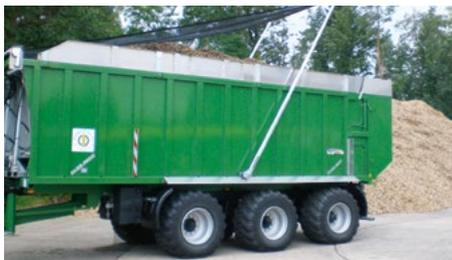
Mit einer Laderaumabdeckung kann bei leichteren Schüttgütern wie Silage oder Holzhackschnitzeln ein Herabfallen verhindert werden. Eine Abdeckpflicht besteht nicht! Mit angepasster Fahrgeschwindigkeit und ausreichendem Abstand zur Bordwandoberkante sind auch ohne Abdeckung Ladungsverluste zu vermeiden.
