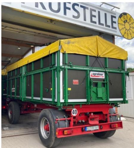
Anhänger mit einer bauartbedingten Höchstgeschwindigkeit von 40 km/h, müssen nur alle zwei Jahre zur Hauptuntersuchung.
