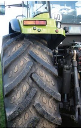
Bei Traktoren bis 40 km/h bbH müssen mindestens 2/3 der Reifenbreite abgedeckt sein.
