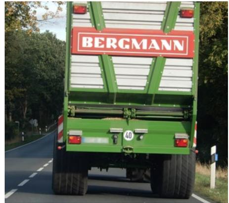
*Das Wiederholen der Beleuchtungseinrichtung oben an der Heckklappe führt zu mehr Sicherheit. Insbesondere bei Abbiegevorgängen können nachfolgende Fahrzeuge das Blinken schon von Weitem erkennen, auch wenn Pkw direkt hinter dem Anhänger fahren und die untere Beleuchtung dadurch verdeckt ist.*
