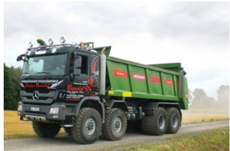
*Sonderfahrzeug, das zur Ausbringung von Mist, Kompost oder Klärschlamm geeignet ist.*
