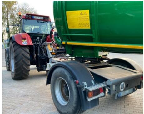
*Das Fahrzeug mit der niedrigsten bauartbedingten Höchstgeschwindigkeit begrenzt die Zuggeschwindigkeit.*
