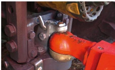
Die Kugelkopfkupplung kann relativ hohe Stützlasten aufnehmen. Eine regelmäßige Überprüfung des Verschleißzustands ist zu empfehlen.
