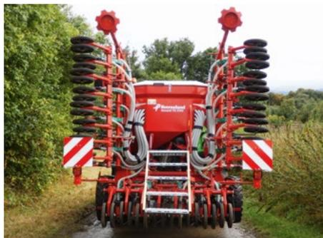
*Beleuchtungseinrichtungen an Anbaugeräten. Die Warntafeln sind für die Kenntlichmachung und Absicherung verkehrsgefährdender Teile erforderlich.*
