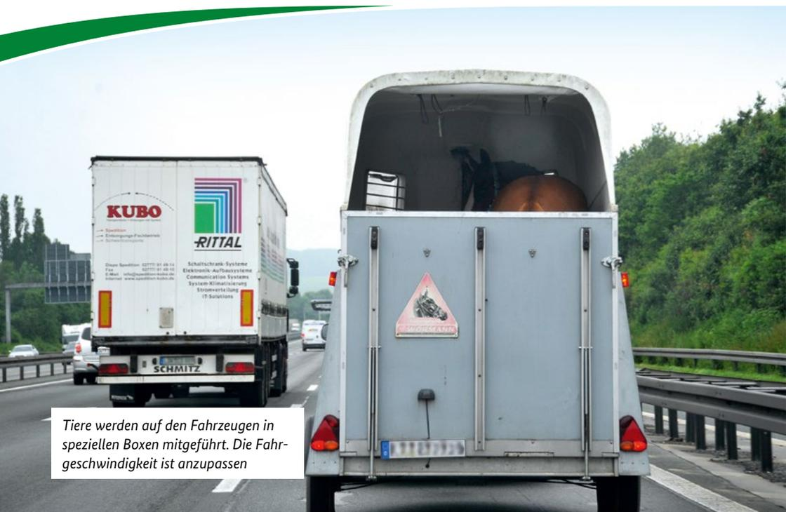
Tiere werden auf den Fahrzeugen in speziellen Boxen mitgeführt. Die Fahrgeschwindigkeit ist anzupassen
