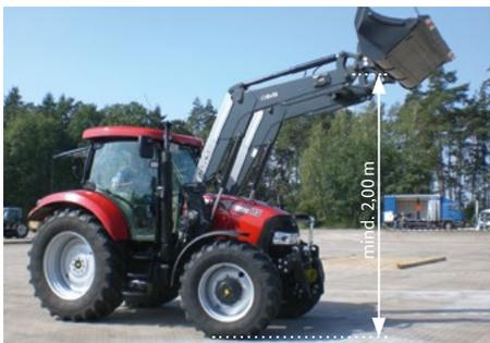
Ohne Kenntlichmachung und Absicherung muss der Mindestabstand zwischen Fahrbahn und Unterkante Frontladerschwinge bzw. Arbeitswerkzeug mindestens 2 m betragen.
