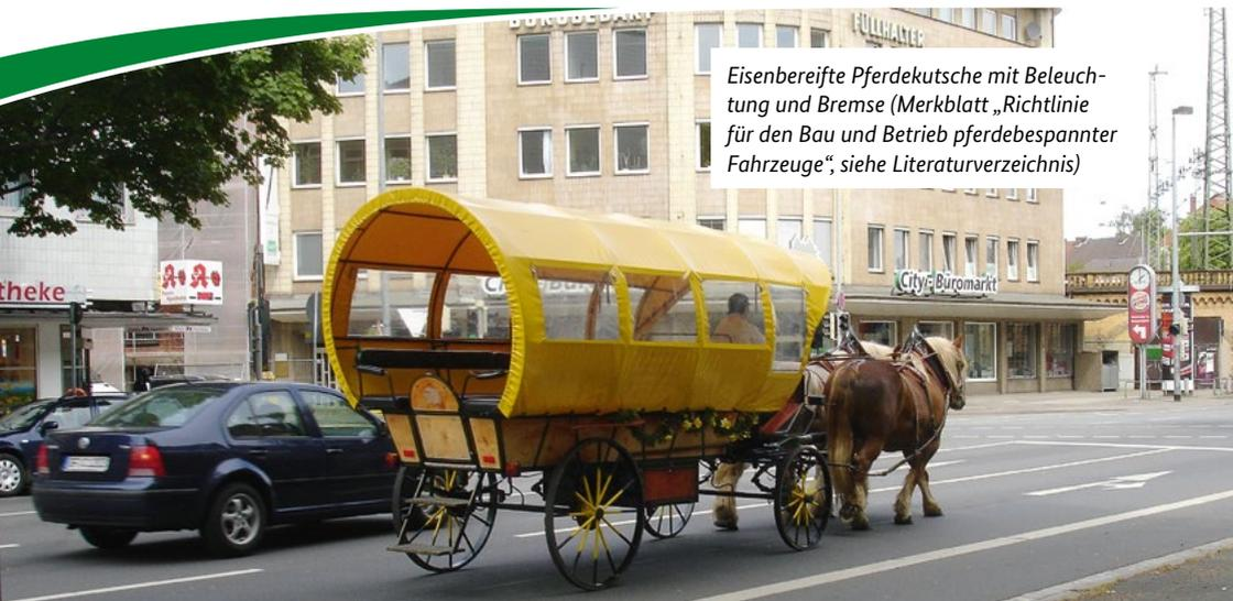
*Eisenbereifte Pferdekutsche mit Beleuchtung und Bremse (Merkblatt „Richtlinie für den Bau und Betrieb pferdebespannter Fahrzeuge“, siehe Literaturverzeichnis)*
