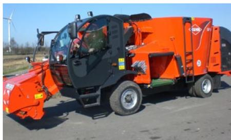
*Bis zu einer Zulassung von 25 km/h darf der selbstfahrende Futtermischwagen als selbstfahrende Arbeitsmaschine auch auf der Straße Futter transportieren.*
