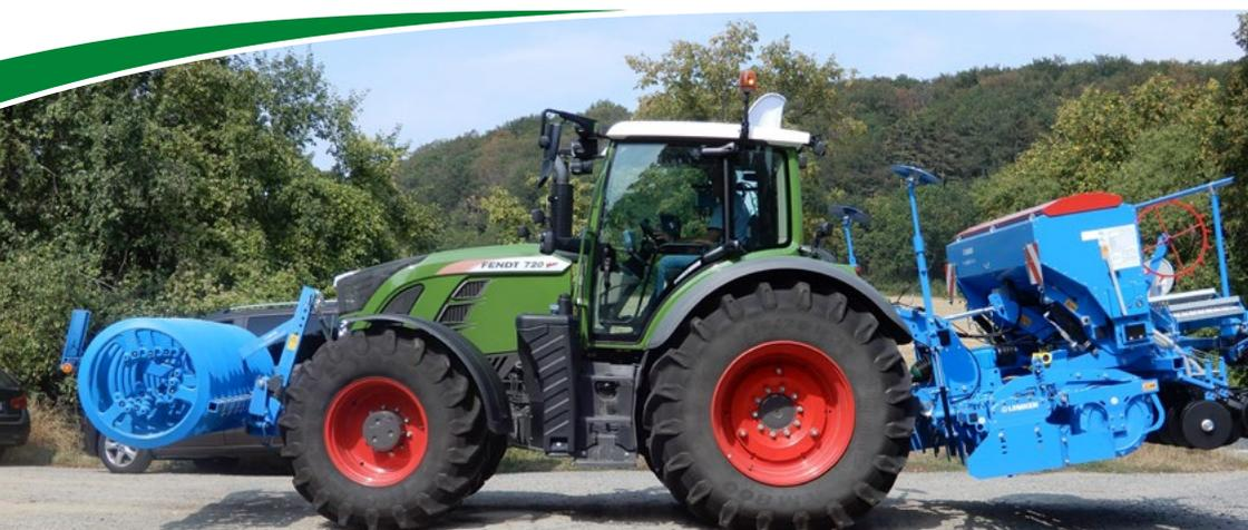
*Vorsicht bei Traktoren mit Front- und Heckanbaugeräten bei hoher Fahrgeschwindigkeit. Gefederte Vorderachsen und Schwingungstilgung der Heckhydraulik sind vorteilhaft.*
