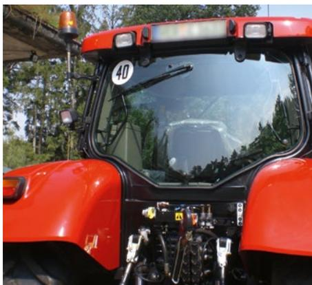
Traktor mit „40“-Schild. Traktoren mit über 32 bis 60 km/h bbH müssen heckseitig ein entsprechendes Geschwindigkeitsschild mitführen.
