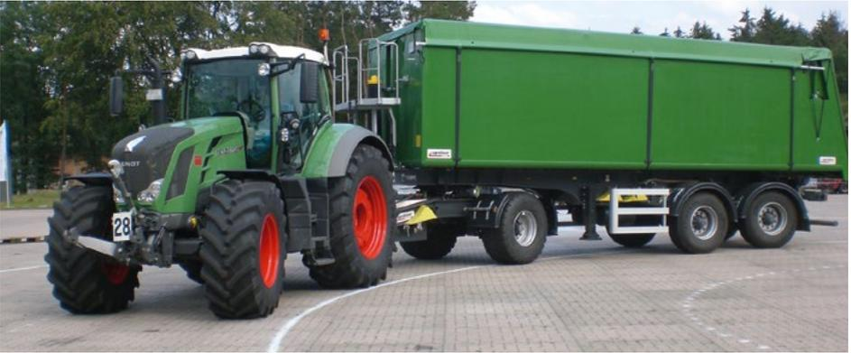
Bei einem Zug mit mehr als 4 Achsen kann, unter Berücksichtigung der zulässigen Einzelgewichte der Fahrzeuge und der Achslasten, das zulässige Gesamtgewicht max. 40 t betragen.
