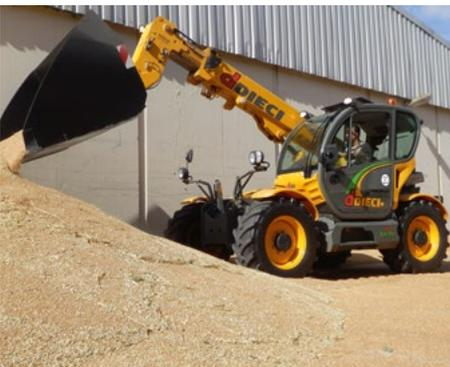
Das 20 km/h-Schild kennzeichnet den Teleskop- lader als zulassungsfreie sFA.
