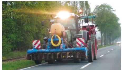
*Verdeckte Scheinwerfer werden oben am Schlepperdach oder am Arbeitsgerät wiederholt. Es darf nur ein Scheinwerferpaar eingeschaltet sein und auch die Geschwindigkeit von 30 km/h ist einzuhalten (§ 50 Abs. 3 Nr. 2 StVZO). Auch verdeckte Begrenzungs- und Blinkleuchten sind zu wiederholen.*
