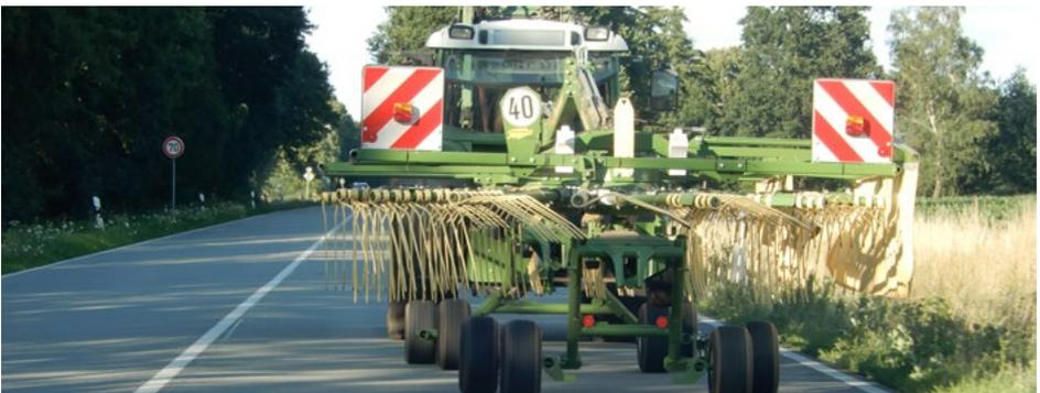
Angehängte Arbeitsgeräte sind wie Transportanhänger kenntlich zu machen. Auch hier dienen die Warntafeln zusätzlich zur Absicherung der verkehrsgefährdenden Teile.
