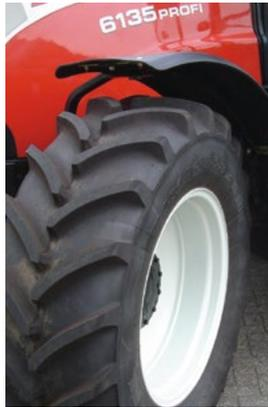
Die Radabdeckungen müssen vorn und hinten gleichermaßen bei mehr als 25 km/h Höchstgeschwindigkeit vorhanden sein.
