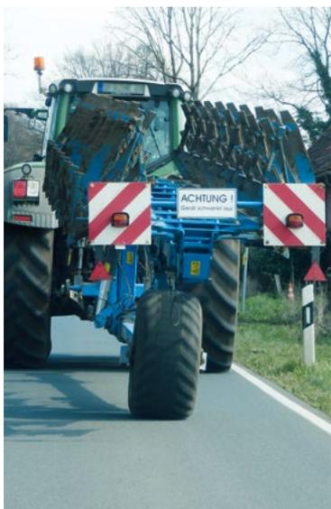
*Durch den aufgesattelten Pflug wird die Lenkfähigkeit des Schleppers verbessert.*
