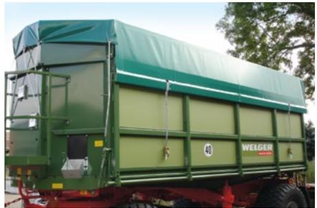
*Getreide wird in der Regel abgedeckt. Dies kann gleichzeitig als Ladungssicherung dienen. Leichte Güter wie Spreu, Papiertüten etc. können ebenfalls so gesichert werden.*
