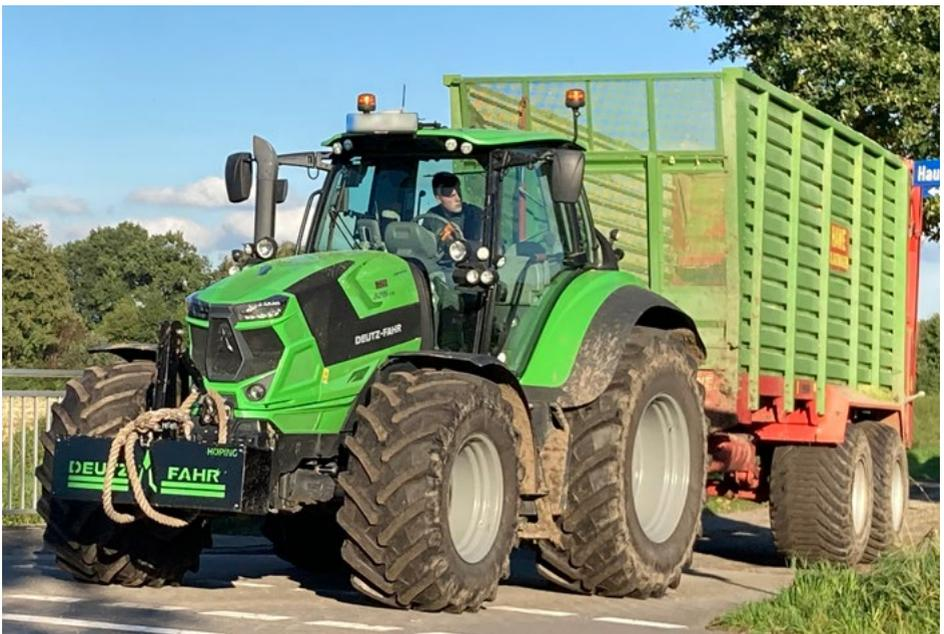
Fahrzeuge für die praktische Ausbildung Klasse T. Zugmaschinen bis 60 km/h und ein zugelassener Anhänger mit Zweileitungsbremssystem.
