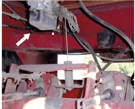
Bei Fahrtantritt ist der Hebel des Anhänger-Bremskraftreglers in die dem Beladungszustand entsprechende Stellung zu bringen (Leer, ½ Last, Beladen). Sicherer lässt sich dies über lastabhängige automatische Bremskraftregler (ALB) (Pfeil Bild unten) realisieren.
