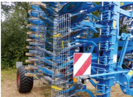
Die verkehrsgefährdenden Teile sind an der Kurzscheibenegge mit Warntafeln kenntlich gemacht und mit Gittern abgedeckt worden.
