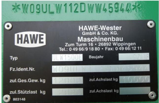
*Die FIN ist im Fahrzeugrahmen eingeschlagen und auf dem Fabrik-schild angegeben.*
