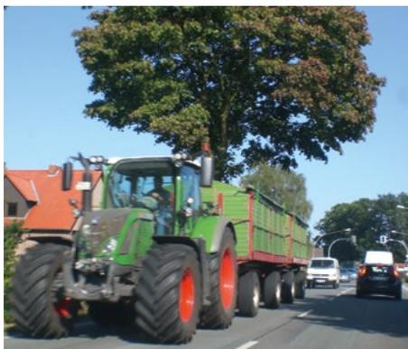
*Langsam durch Ortschaften fahren! Bei Gefahrenbremsungen liegen die Anhaltewege auf trockener Fahrbahn bei Höchstgeschwindigkeiten zwischen 40 – 60 km/h je nach Reaktion und Bremsweg um die 30 m.*
