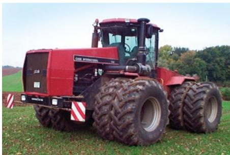
Mit Doppel- oder Zwillingsbereifung können Gesamtbreiten von über 3,50 m entstehen. Bei mehr als 3 m Breite sind eine Ausnahmegenehmigung gemäß § 70 StVZO und eine Erlaubnis nach § 29 StVO erforderlich.
