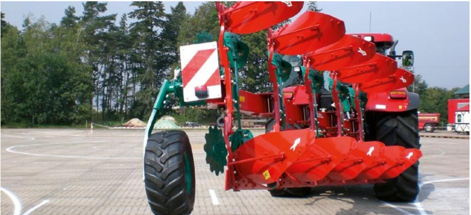
Die Beleuchtungseinrichtungen dürfen zur Kenntlichmachung von Arbeitsgeräten auf die Warntafeln aufgebracht werden. Warntafeln weisen auch auf verkehrsgefährdende Bauteile hin.
