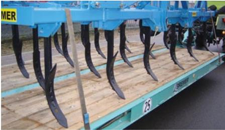
*Das Arbeitsgerät (Maschinentransport) wird durch Spanngurte niedergezurrt. Die Scharspitzen setzen sich im Holzboden fest. Das Arbeitsgerät ist ausreichend gesichert.*
