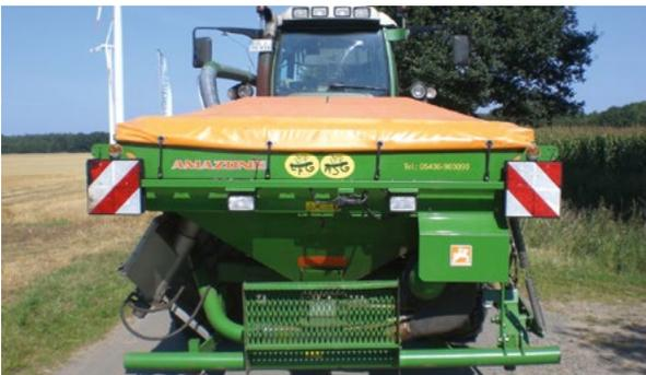
Frontanbaugerät mit seitlicher Kenntlichmachung und Beleuchtung.
