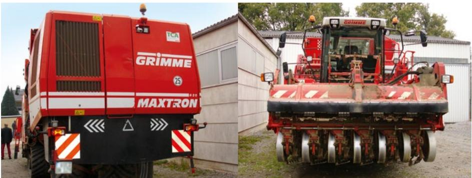
*SfA – Rübenroder – front- und heckseitige Beleuchtung und Kenntlichmachung. Heckseitige Markierung – schwenkt aus. Sicht nach hinten wird durch ein Kamerasystem unterstützt.*
