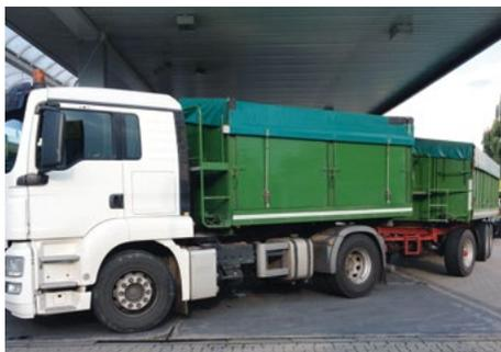
*Bei der Zugmaschine – umgebauter Lkw – SN: 87 0000 darf die Nutzmasse das 0,4-Fache der zulässigen Gesamtmasse betragen. Sie wird gerne in Verbindung mit einem dreiachsigen Anhänger eingesetzt.*
