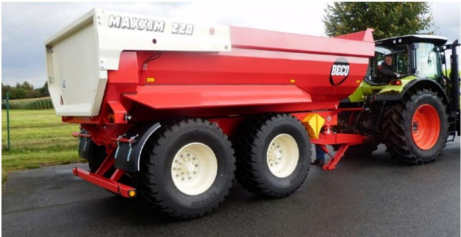
Der hintere Unterfahrschutz am Anhänger ist vorgeschrieben. Seitliche Schutzvorrichtungen sind nicht erforderlich. Auch nach VO (EU) 167/2013 nicht, da der Kipper auf 40 km/h zugelassen ist.
