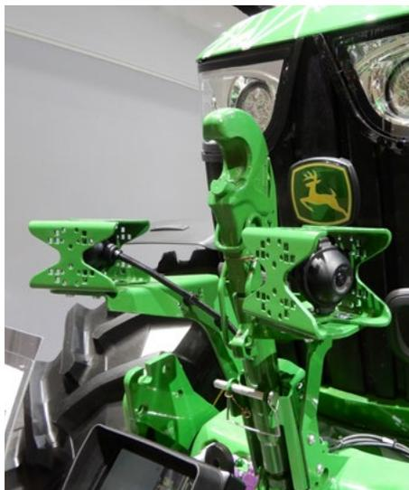
Zur Ausgleichung der Sichtfeldeinschränkungen zertifiziertes Vorbau-Kamera-Monitor-System (VKMS)
