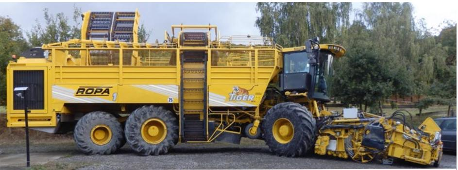
Zulässige Abmessungen und Gewichte eines sfA (Einzelfahrzeug): Länge 12 m, Breite 3 m, Höhe 4 m, Achslast 11,5 t bei angetriebenen Achsen, zG dreiachsig 25 t (bei Überschreitungen wird eine Ausnahme benötigt, siehe Punkt 5.6).
