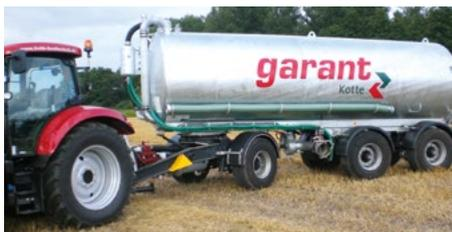
Fasswagen sollen im Behälter über Schwallwände verfügen. Sie schränken das Schlingern der Flüssigkeit ein. Fässer, die auf Anhängern mitgeführt werden, müssen gesichert sein. Bei „halbvollen“ Behältern ist die Fahrgeschwindigkeit anzupassen.
