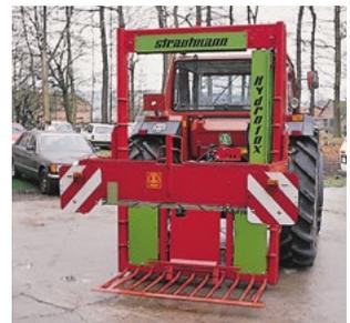
Kenntlichmachung eines Siloblockschnaiders – verkehrsgefährdendes Bauteil – mit abnehmbarem Leuchtenträger.
