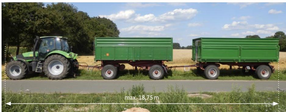
Bei der maximalen Zuglänge von 18,75 m wird von der äußersten Vorderkante bis zur Hinterkante des letzten Anhängers gemessen.
