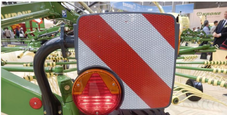
*Nach der Verordnung (EU) 167/2013 können Signaltafeln auch mit der Beleuchtung kombiniert werden, wenn bestimmte Rahmenbedingungen eingehalten werden; hier im Bild Warntafel mit rechtsseitiger Ausrichtung.*
