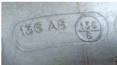
Die Geschwindigkeit und Reifentragfähigkeit sind auf dem Reifen durch Zahlen und Buchstaben dargestellt. A8 (40 km/h) und B (50 km/h); 136 (2.240 kg Tragfähigkeit). Entsprechende Tabellen stellen die Reifenhersteller zur Verfügung oder sind im Internet zu finden.
