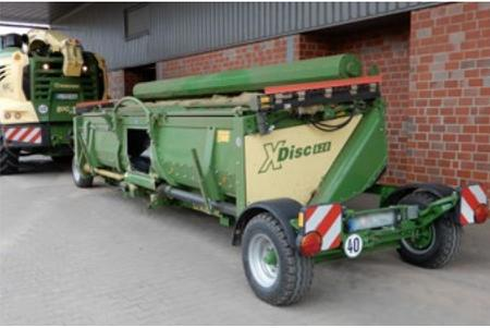
Hinter einer sFA darf nur ein Anhänger mitgeführt werden, der ausschließlich der Zweckbestimmung der sFA dient.
