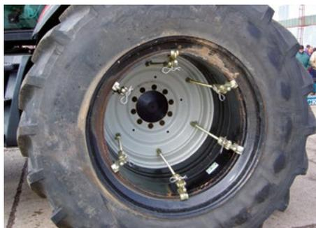
Die Zwillingskupplungen sind entsprechend der Motorleistung und Höchstgeschwindigkeit des Traktors zuzuordnen. Die Hinweise der Hersteller sind zu beachten.
