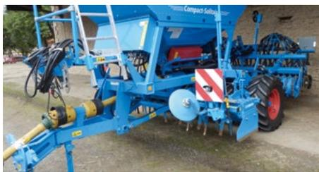
Bei angehängten Arbeitsgeräten muss ab 3 t Achslast eine Bremse vorhanden sein.
