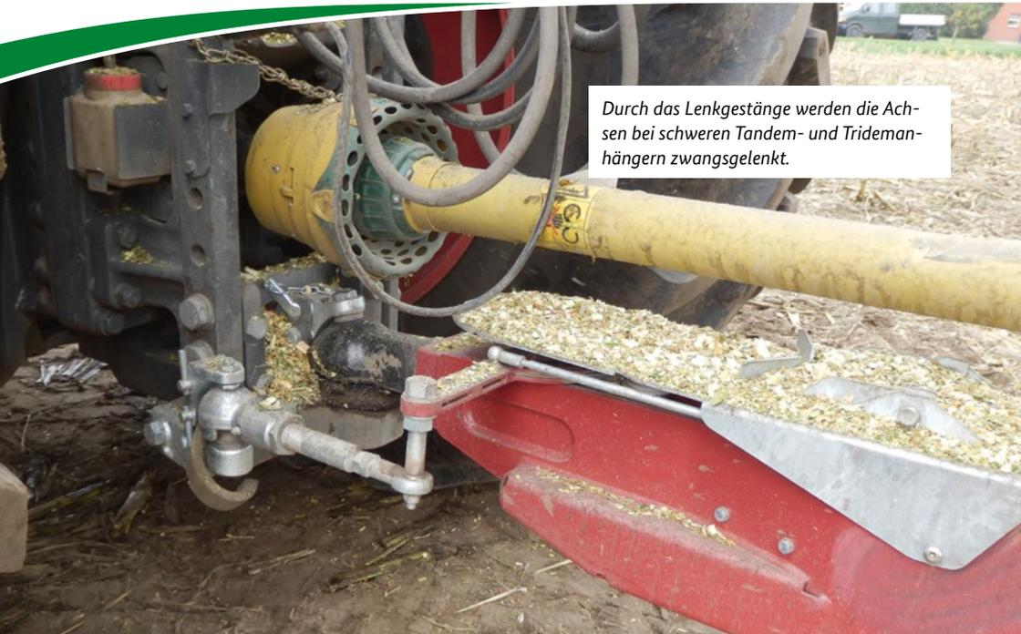
Durch das Lenkgestänge werden die Achsen bei schweren Tandem- und Tridemanhängern zwangsgelenkt.
