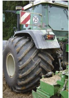
Mit Reifen, die weniger als 2/3 abgedeckt sind, darf die Geschwindigkeit von 25 km/h nicht überschritten werden.
