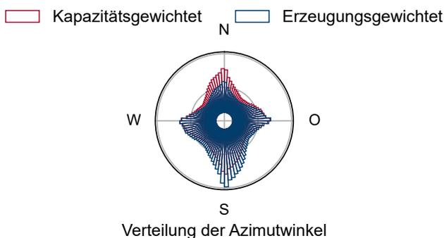
**Abbildung 4.12:** Kapazitäts- und erzeugungsgewichtete Verteilung der Azimutwinkel der Dachflächen in Deutschland.
