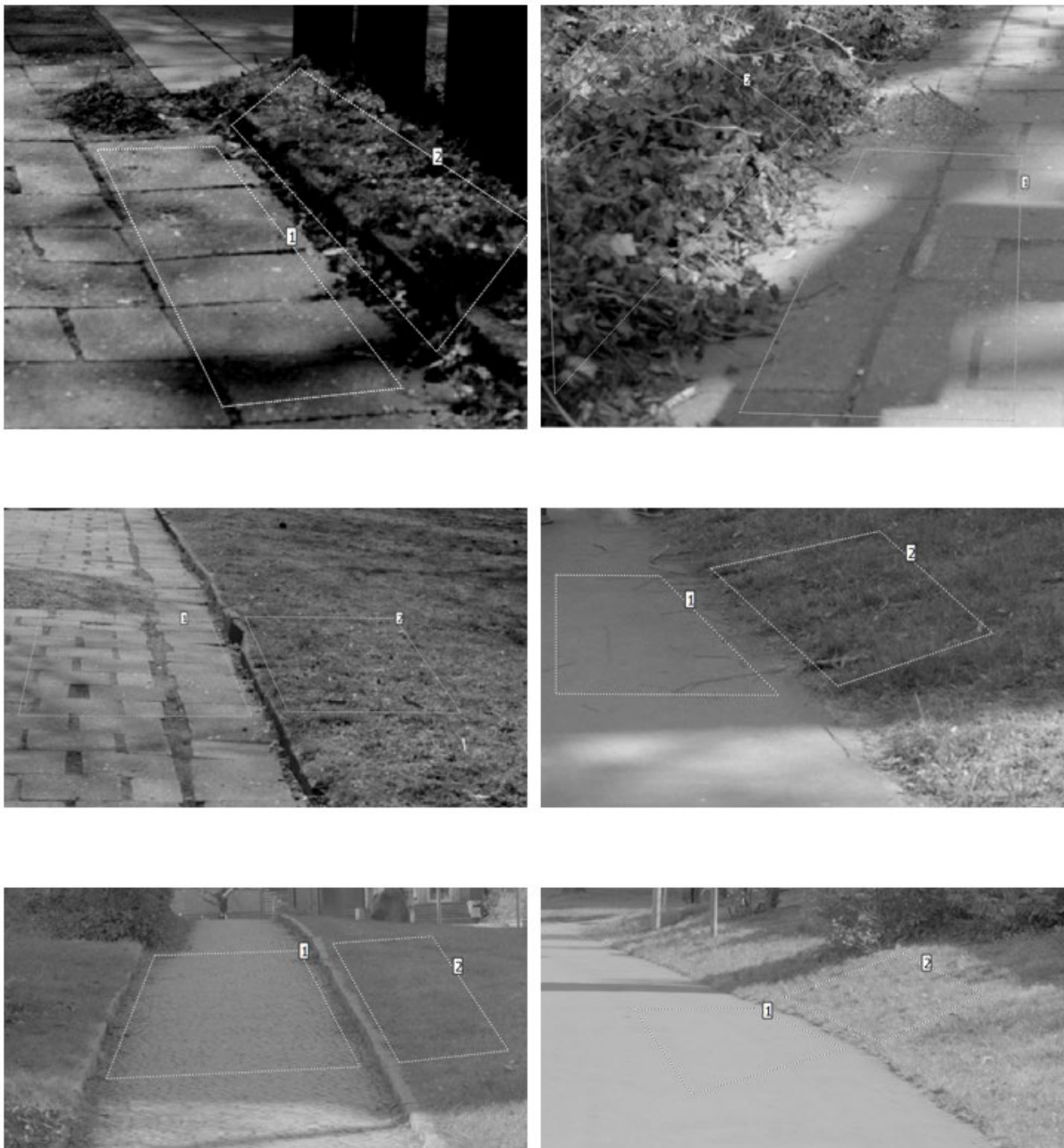
Abbildung 14: Leuchtdichteaufnahmen zur Ortsbegehung (Graustufen mit logarithmischer Skalierung): praktische Situation mit Kontrastwirkung von an befestigte Wege angrenzende Grünflächen (oben links: K_m=0,39 ; oben rechts: K_m=0,36 ; Mitte links: K_m=0,32 ; Mitte rechts: K_m=0,31 ; unten links: K_m=0,28 ; unten rechts: K_m=0,28 )
