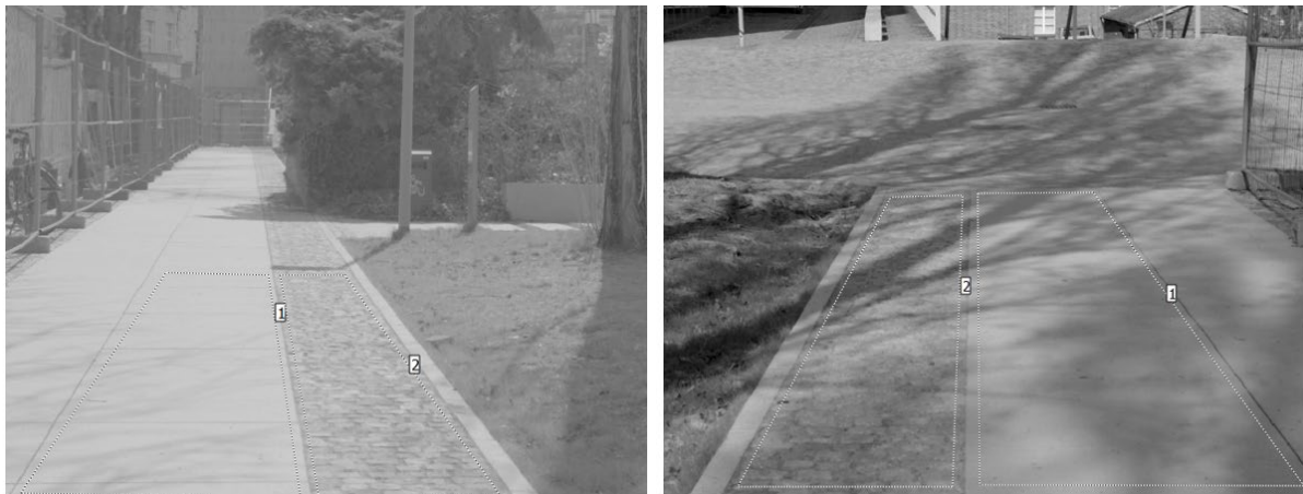
Abbildung 13: Leuchtdichteaufnahmen zur Ortsbegehung (Graustufen mit logarithmischer Skalierung): praktische Situation eines Gehweges mit seitlichem Streifen aus Kleinpflaster (links: Messung in einer dem Sonnenstand zugewandten Richtung; rechts: Messung in der dem Sonnenstand abgewandten Richtung)
