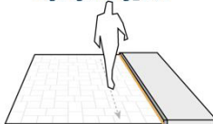
Variante 2.1: Visueller Kontrast der Kante zur Gehfläche ist erforderlich
