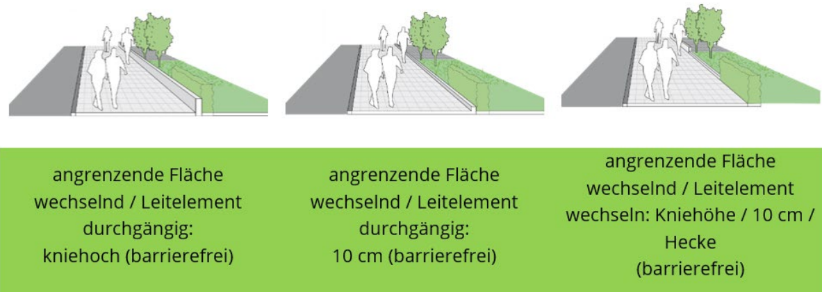
Abbildung 31: einige Gestaltungsvarianten der Diskussion in Kleingruppen zu Varianten wechselnder angrenzender Flächen in Kombination mit Varianten taktiler Leitelementen im Expertenworkshop
