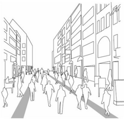
Zonierung durch zwei Leitstreifen ( \geq 30\text{cm} breit, taktil/visuell kontrastierend)
