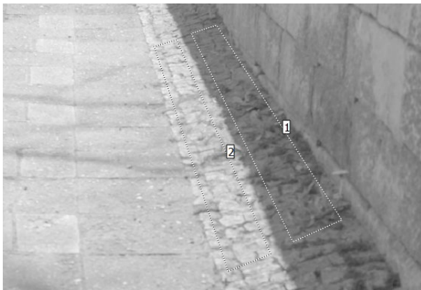
Abbildung 10: Leuchtdichteaufnahme zur Ortsbegehung (Graustufen mit logarithmischer Skalierung): praktische Situation bei gerichteter Beleuchtung aufragender Kanten mit Schattenwurf der aufragenden Kante (Detail zur Kontrastwirkung von Schatten auf Bereich mit einheitlichem Material)
