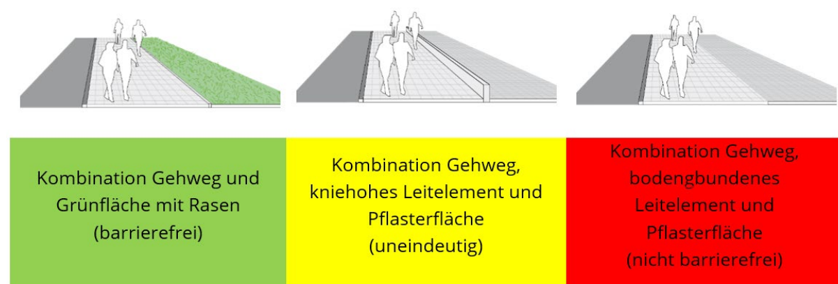
Abbildung 30: einige Gestaltungsvarianten der Diskussion in Kleingruppen zu Höhenvarianten taktiler Leitelemente mit Varianten angrenzender Flächen im Expertenworkshop
