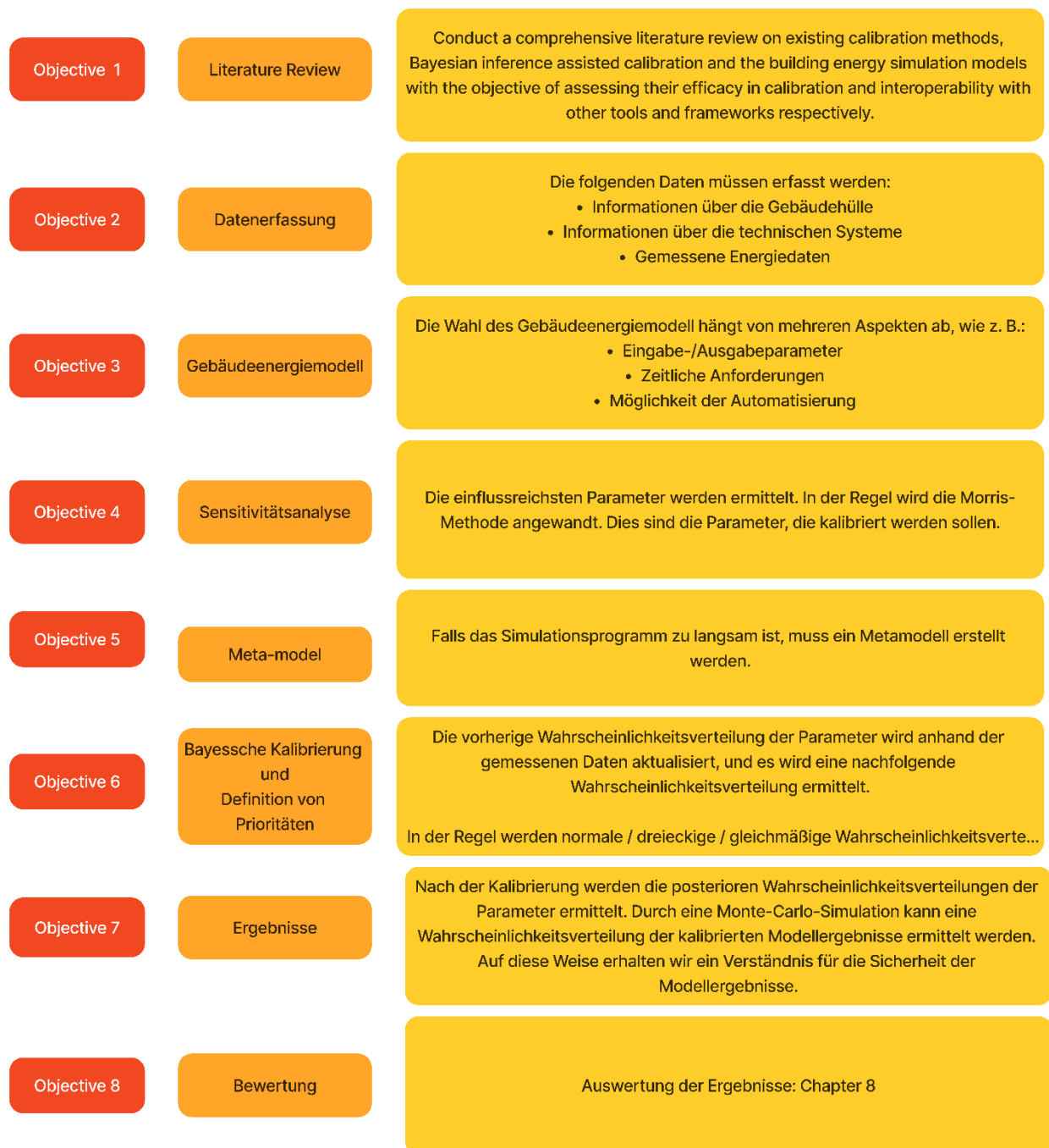
Abbildung 3 gibt einen umfassenden Überblick über die wichtigsten Ziele und Schritte bei der Entwicklung einer interoperablen Open-Source-Bayesian-Kalibrierung von Gebäudeenergiesystemen
