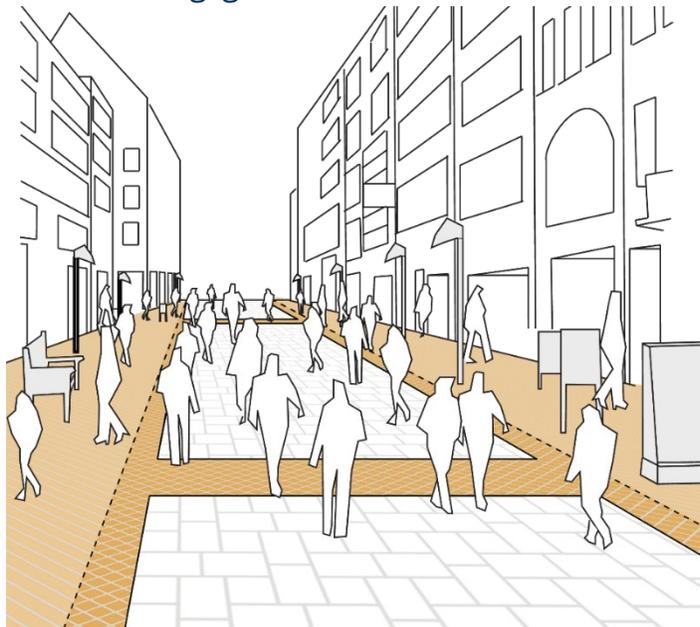
Schematische Darstellung 1: Zusammensetzung einer Fußgängerzone mit beidseitigen Leitlinien durch Begrenzung der Ausstattungzone und zusätzlicher Segmentierung der Gehfläche in Laufrichtung
