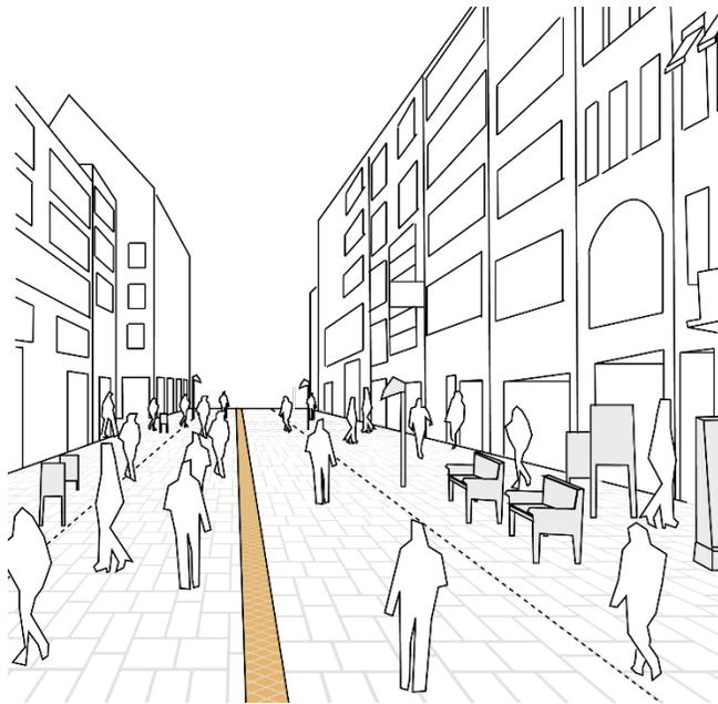
Schematische Darstellung 1: Zusammensetzung einer Fußgängerzone mit zentral angeordnetem Leitstreifen
