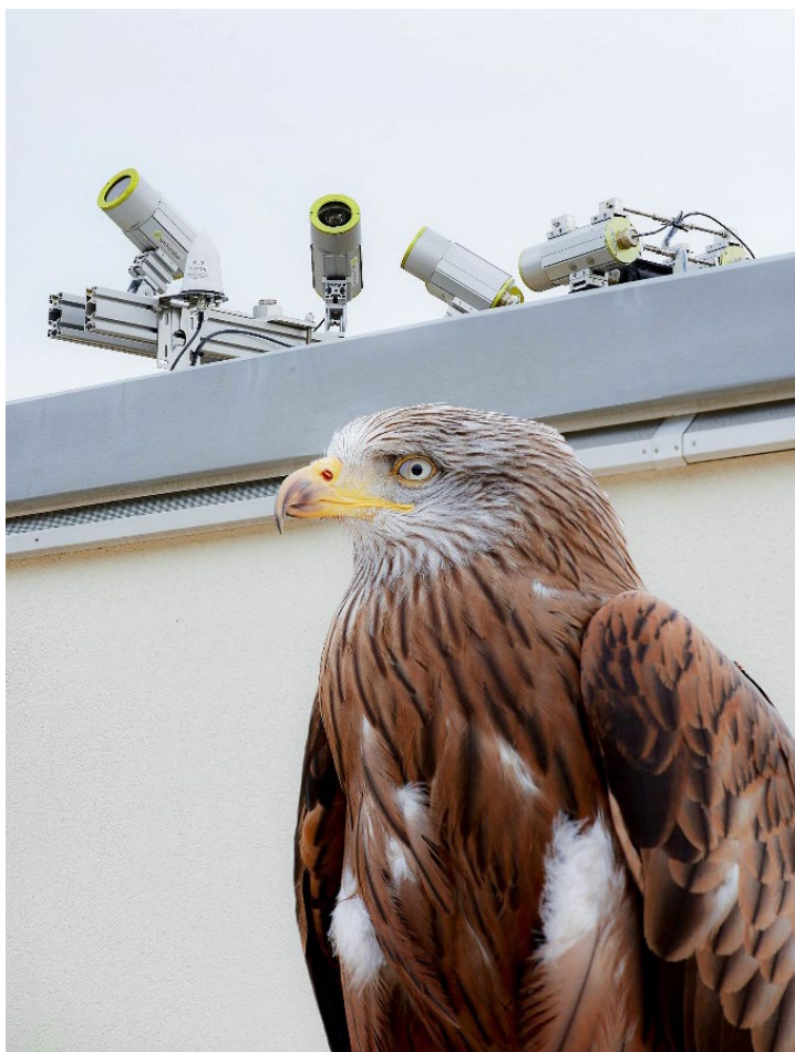
Abb. 1 Das Antikollisionssystem Bird- und BatRecorder (BBR 2.0) zusammen mit dem Rotmilan Lucia. (Quelle: D. Arzt)
