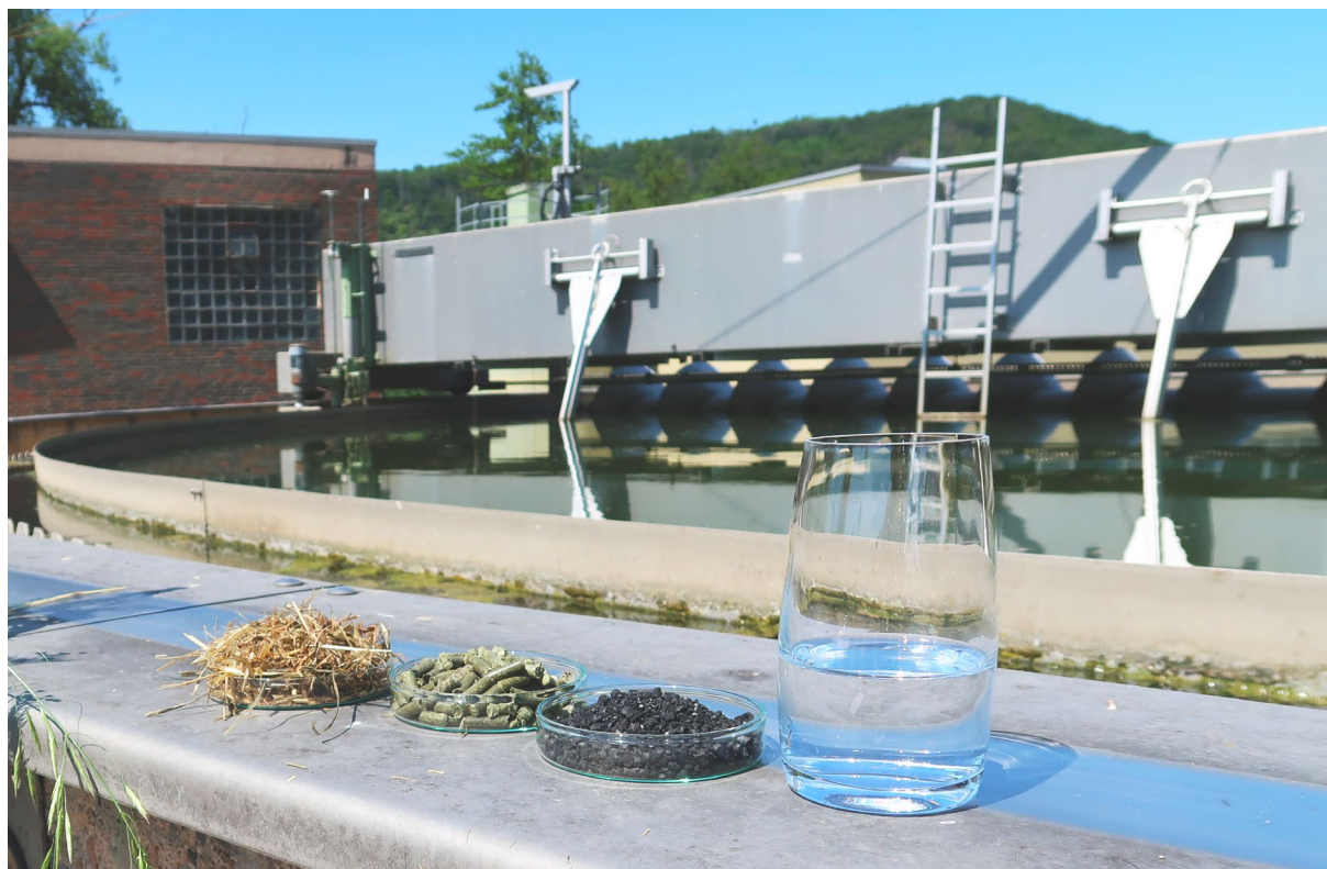
Abb. 1: Herstellungsprozess von Grassilage zu Aktivkohle für die Abwasserreinigung: Von Grasschnitt über Pellets und Aktivkohle bis hin zu sauberem Wasser (Quelle: K. Kaetzl)
