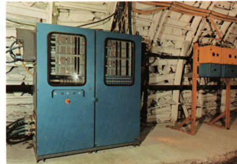
Abb. 29: Übergeordnete Steuerung und Regelung
