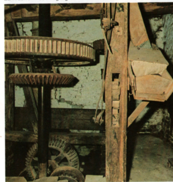
Zahnradwerk: Übertragung der Wasserkraft
