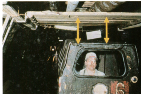
Bild 1: Sicherheitsabstand zwischen Lokomotive und Unterkannte Bühne (11)
