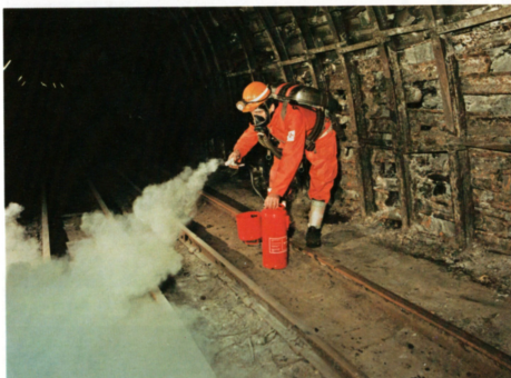
Einsatz eines Pulverlöschers PK 10 (u) BuT
