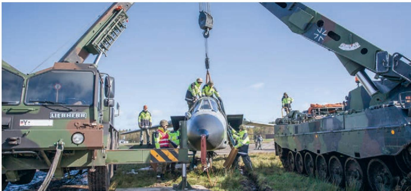
Ein Bergepanzer Büffel und ein Fahrzeugkran mittel FKM heben einen Kampffjet vom Typ Tornado im Rahmen der Bergeübung Elephant Recovery 2016 auf dem Fliegerhorst Jever in Schortens.
