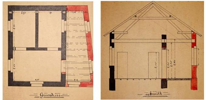
Der trapezförmige Anbau beträgt in den Außenmaßen 1,78 m bis 2,52 m und im Inneren 1,38 m bis 2,12 m. Durch den Anbau vergrößert sich das gesamte Gebäude im Außenbereich auf 6,52 m x 7,37 m bzw. 6,63 m.
