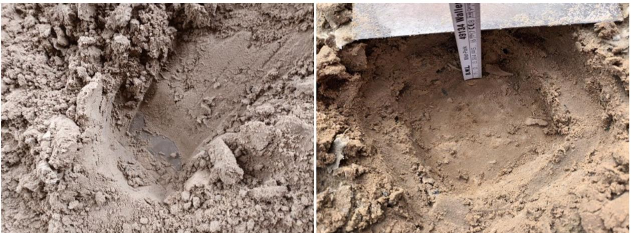
Abbildung 37: Feldversuche – Sperrschicht: deutliche Trennung zwischen lockerer oberer Schicht und fester Sperrschicht (links), mehrere Sperrschichten (rechts)
