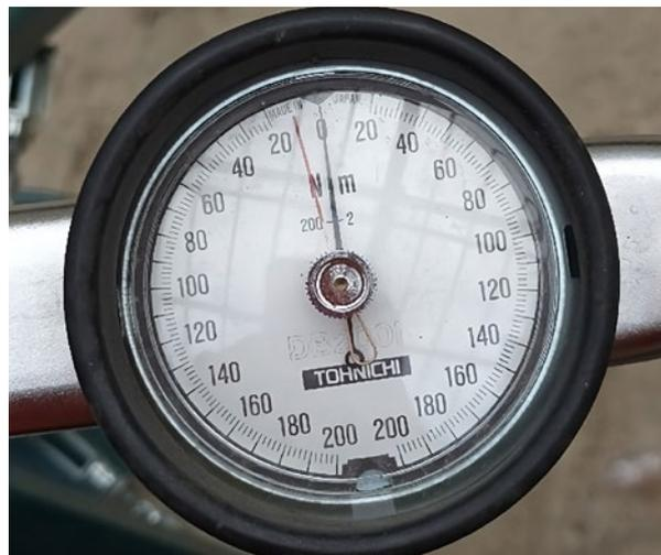
Abbildung 32: Versuchshalle – Anzeige Drehwiderstandsgerät während einer Messung
