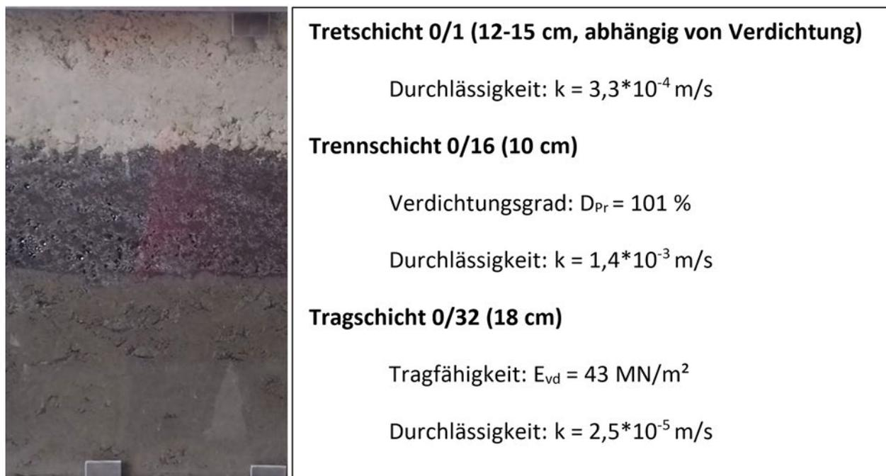
Abbildung 15: Versuchshalle – Schichtaufbau der Versuchsfläche
