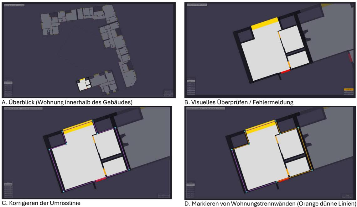
Abbildung 9: Überblick über den Prozess der Grundrissprüfung mit dem eigens entwickelten Reviewing-Tool.
