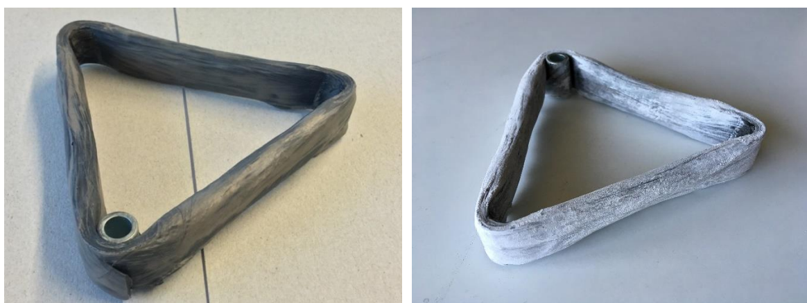
Abbildung 9: Gewickelter 3-Eck direkt nach der Fertigung (links) und sechs Monate später (rechts) ohne Klarlack, Lagerung bei üblichem Raumklima
