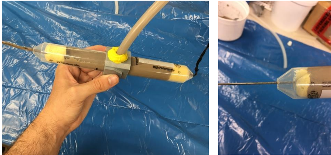
Abbildung 14: Versuche mit einer Imprägnierkammer mit Schaumdichtungen
