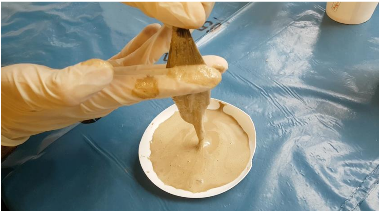
Abbildung 3: Handimprägnierung von einzelnen Rovingen
