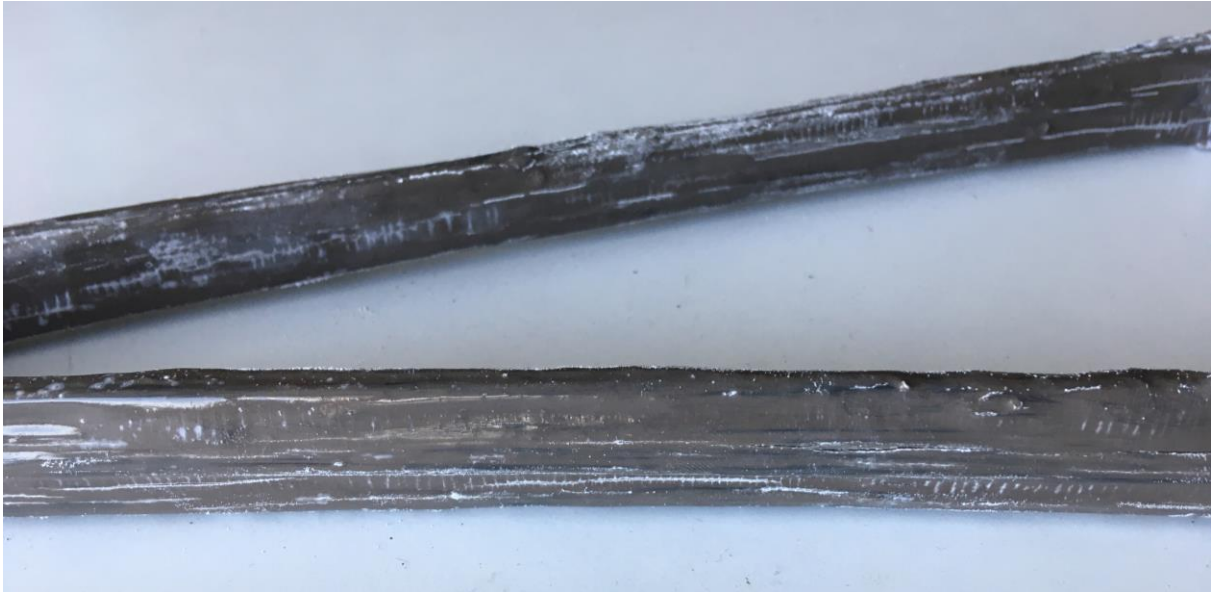
Abbildung 10: Mit Klarlack beschichteter Prototyp sechs Monate nach Aushärtung, hier treten die weißen Ausscheidungen reduziert auf
