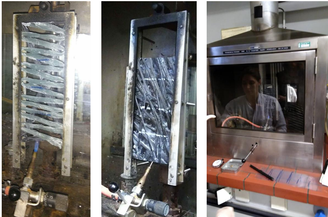
Abbildung 12: Orientierende Brandversuche auf normalentflammbar B2 DIN 4102
