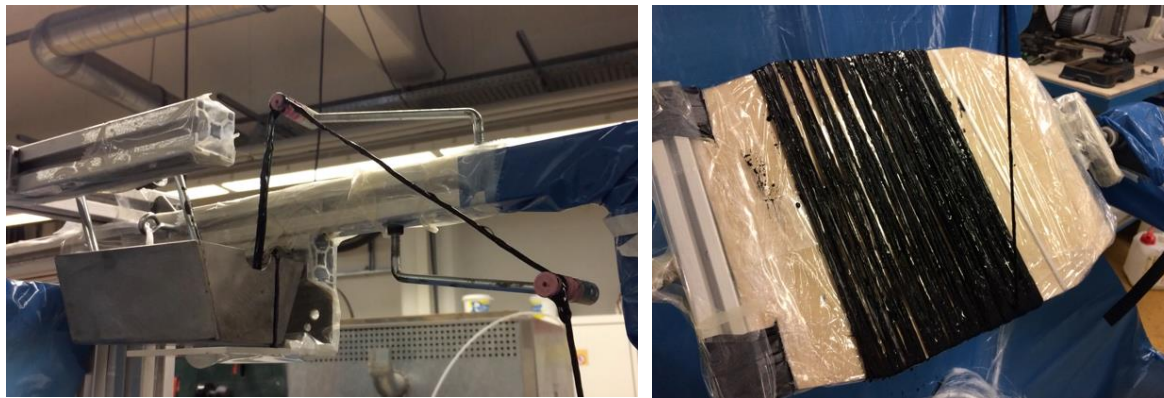
Abbildung 13: Anpassung der vorhandenen Wickelmaschine
