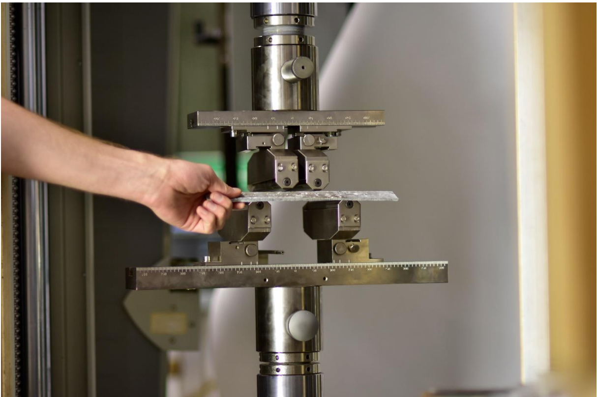
Abbildung 11: Biegeversuch eines Bauteils aus faserverstärkter Keramik
