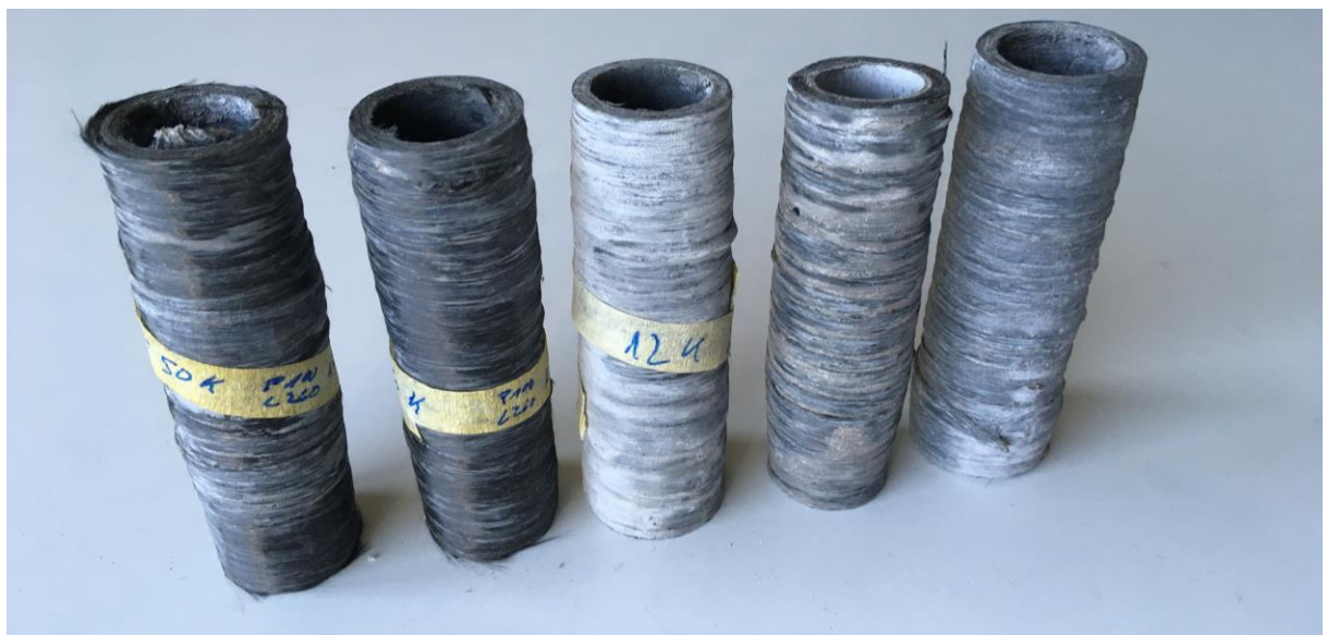
Abbildung 15: Wickeln von rohformigen Probekörper auf einer Wickelmaschine des Typen X-Winder 4X-23 und Auswahl einiger erstellter rohformiger Probekörper
