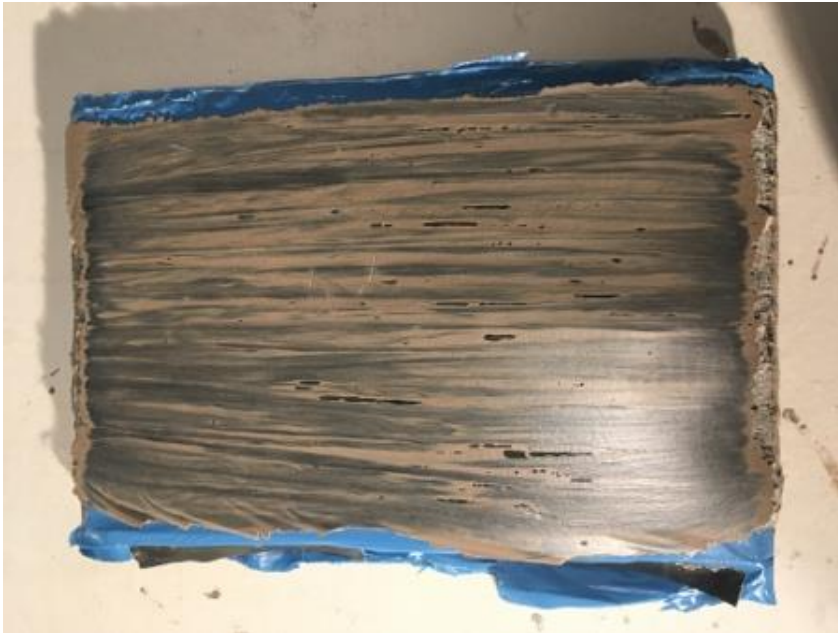
Abbildung 16: Gewickelte Platte mittels Stampf-Imprägnierung
