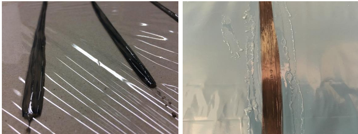
Abbildung 8: Carbon-Roving mit K3 (links) und allein mit pyrogener Kieselsäure (und Wasserglas) imprägniert (rechts)
