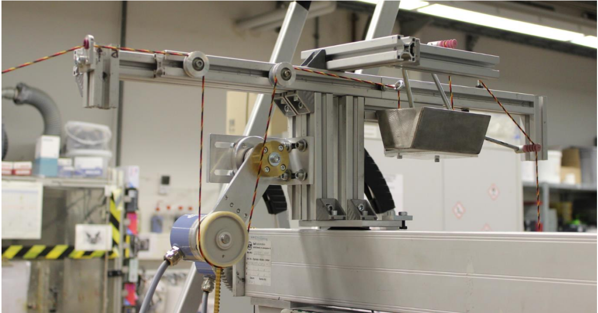
Abbildung 2: Entwickelte Imprägniereinheit der Wickelmaschine
