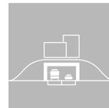
Geschlossene Umhausung ebener Straßen- oder Gleistrasse mit Überbauung, teilweise in die Topographie integriert
